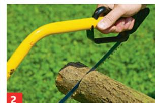
**Anschnitt:** Ist der Schnittkanal tiefer als die Zahnlänge, können Sie mit dem eigentlichen Sägevorgang beginnen. Die Säge arbeitet dabei auf Stoß, also vom Anwender abgewandt
