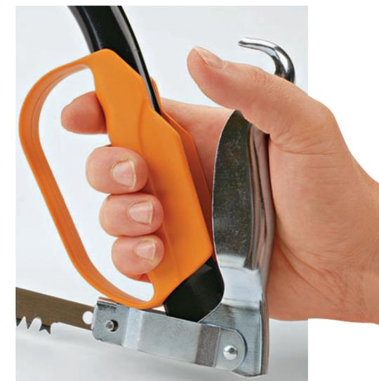
**KLEMMGEFAHR:** An der Spannmechanik von *Fiskars* kann man sich den Handballen besonders empfindlich einklemmen
