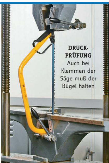
**DRUCK-PRÜFUNG** Auch bei Klemmen der Säge muß der Bügel halten
