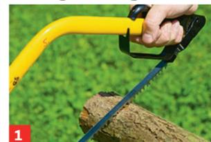
**Ansatz:** Zunächst die Säge an der Schnittstelle leicht aufsetzen und mit geringem Andruck ziehend den Schnittkanal vorsichtig anritzen. Schnittbewegungen zu erst langsam ausführen
