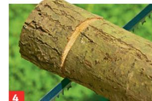
Zum Ende des Sägevorgangs wird die Schnittfuge größer. Jetzt sollte nur noch langsam gearbeitet werden, um ein Abreißen der noch zusammenhängenden Holzfasern zu vermeiden
