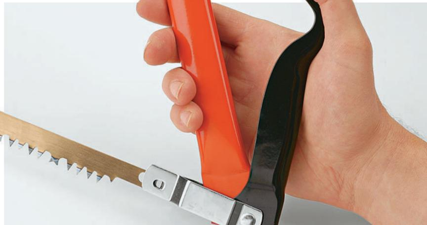
**KLASSISCH** sind solche Hebelspanner, die für die nötige Blattspannung zwischen den Bügelenden sorgen. Allerdings kann man sich oft beim Blattwechsel klemmen, der Hebel liegt außerdem nicht sehr gut in der Hand oder bewegt sich beim Sägen
