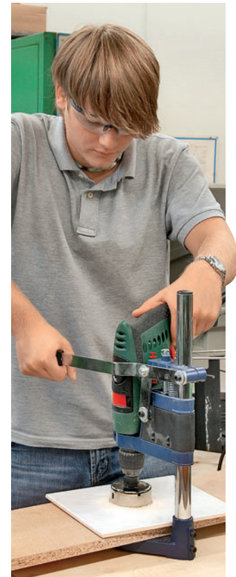
PRAXIS: Bohrungen mit einer Bohrkronen in Fliesen beanspruchen die Mechanik eines Bohrständers besonders. Hier bewertet Tobias Beckmann von der VPA Ergonomie und Präzision
