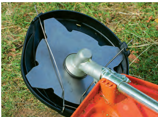
Beim Transport sollten Messerklingen mit einem Schutz versehen werden – hier wird er auf das Messer geklemmt
