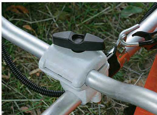
Einige Maschinen ließen sich ohne Werkzeug den unterschiedlichen Körpergrößen unserer Tester anpassen
