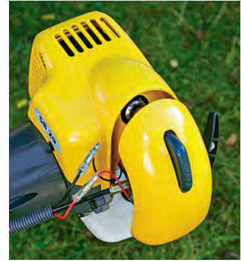
Die freiliegenden Kabel bei Stiga könnten leicht abgerissen werden
