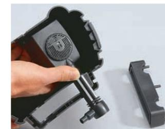
Schwierige Montage: Der Pumpenmotor fand im großen Gehäuse des TIP-Modells nur wenig Halt
