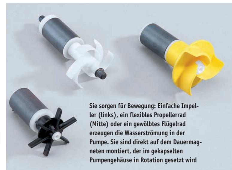
Sie sorgen für Bewegung: Einfache Impeller (links), ein flexibles Propeller (Mitte) oder ein gewölbtes Flügelrad erzeugen die Wasserströmung in der Pumpe. Sie sind direkt auf dem Dauermagneten montiert, der im gekapselten Pumpengehäuse in Rotation gesetzt wird
