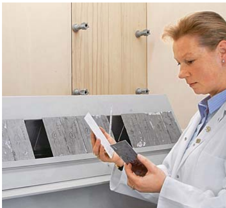
KONDENSWASSERTTEST: Die Prüftafeln werden mit der beschichteten Seite nach unten auf einen oben abgeschlossenen ...
