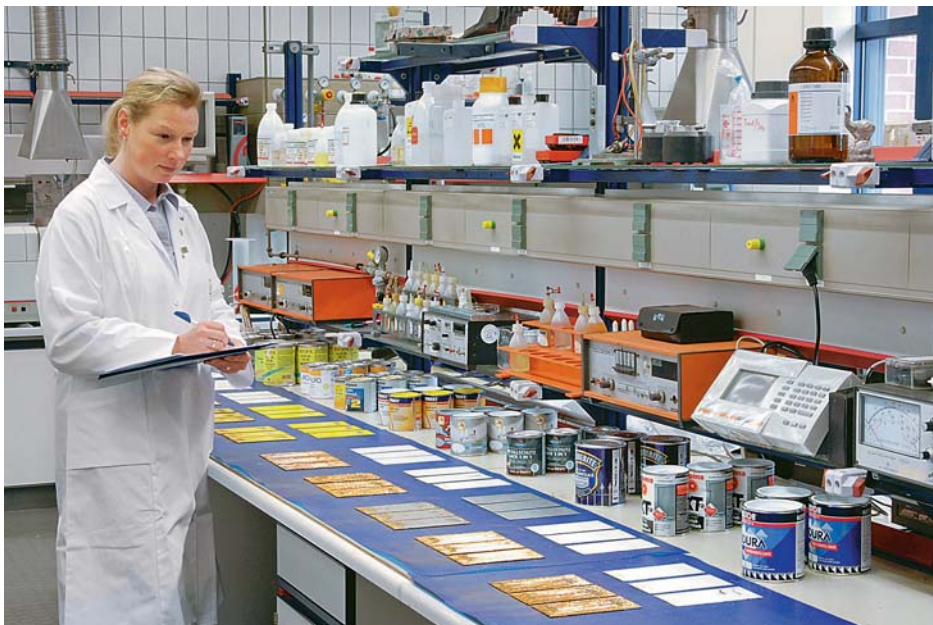
CLAUDIA DIEDRICHS wertet die Testergebnisse aus. Es wurden jeweils drei Testtafeln für Kondenswassertest und Salzsprühkammerprüfung angefertigt, stark vom Mittelwert abweichende Ergebnisse wurden vor der Auswertung ausgeschlossen
