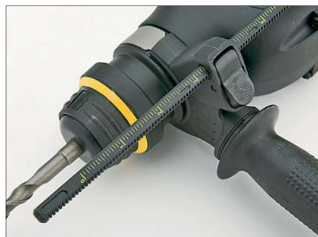
Nicht selbstverständlich: Der Bohrtiefenanschlag bei DeWalt verstellt sich beim Hammerbohren nicht
