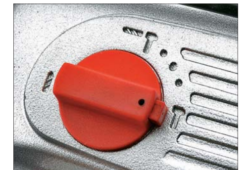
Die Verriegelung am Schalter bei Sparky lässt sich nur schwer betätigen – mit Handschuhen mühsam
