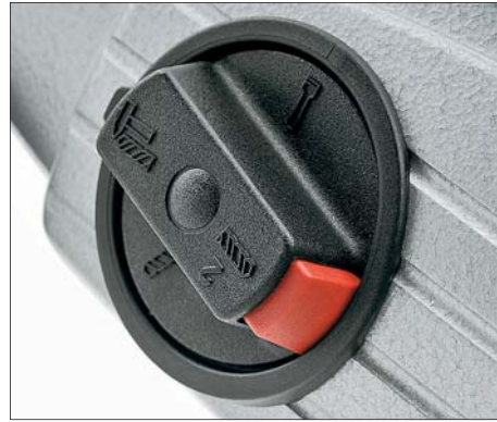
Viele Maschinen bieten – wie hier am Beispiel Metabo – eine übersichtliche Funktionswahl
