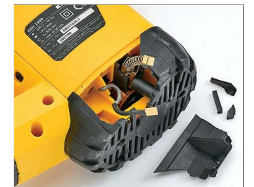
Beim Falltest brach bei Einhell das Motor-Abdeckgitter – elektrische Komponenten könnten berührt werden
