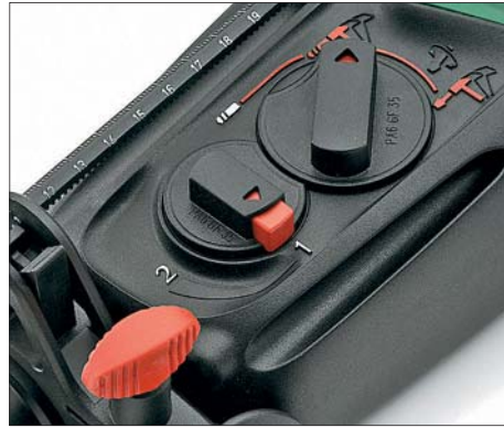
Maschinen mit zwei Gängen sind universeller nutzbar – gehämmert wird stets im ersten Gang
