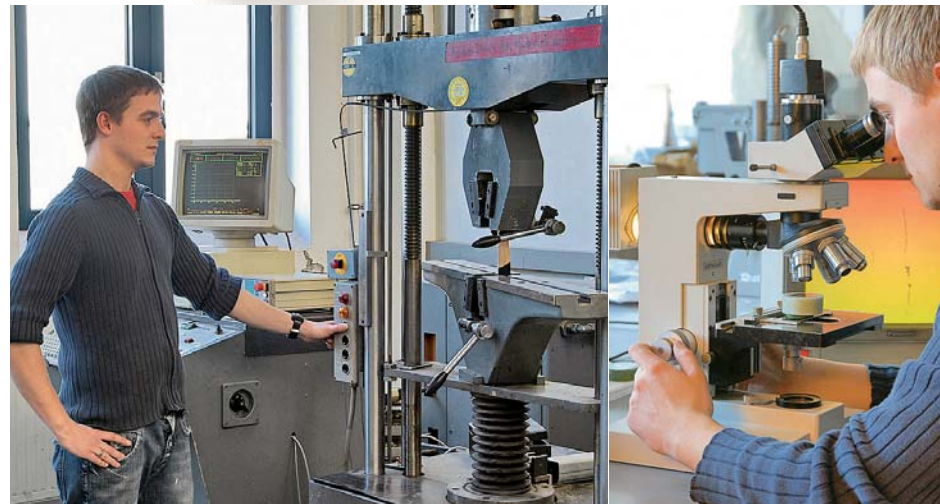
SELBST GETESTET VPA-Prüfer Daniel Napieraj testet die Haltbarkeit der Verbindung von Hammerkopf und -stiel (links). Unter dem Mikroskop zeigen sich Materialverunreinigungen (Bildschirm)
