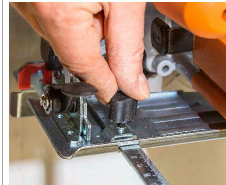
FUMMELEI: Bei Works ist die Arretierung für den Parallelanschlag schwer erreichbar.
