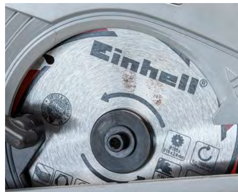
ROST: Bei Einhell zeigte das neue Sägeblatt bereits Korrosions-Spuren.
