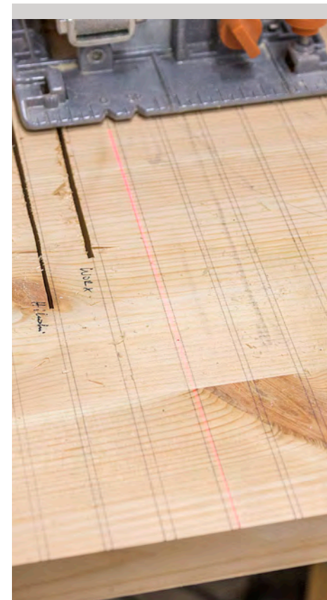
IRRWEG: Bei Batavia sitzt der Laser schief auf dem Gehäuse.
