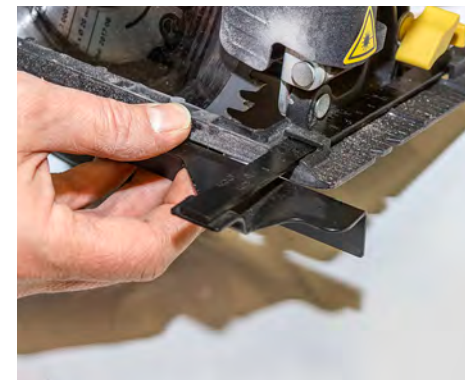
HAKELIG: Der Parallel-Anschlag bei Trotec verbiegt leicht und klemmt dann.
