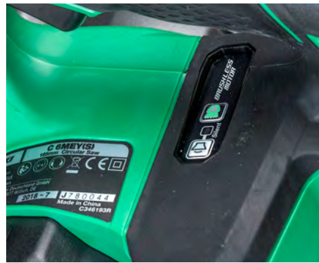
LÄRMSCHUTZ: Bei Hikoki kann die Drehzahl etwas abgesenkt werden.
