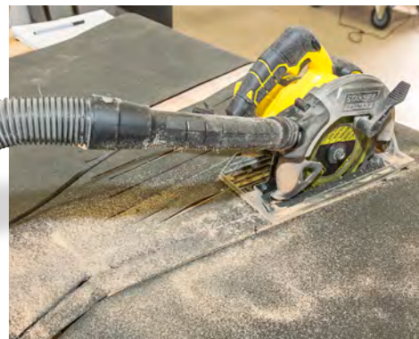
STAUBIG: Trotz Absaugung fliegen oft viele Späne – hier bei Stanley.
