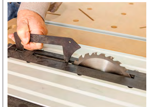
ZUBEHÖR: Alle Geräte können auch stationär betrieben werden – ein Säge-tisch muss aber einen Spaltkeil aufweisen.
