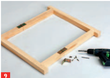
9 Beide Elemente werden mit Scharnieren wieder verschraubt.
