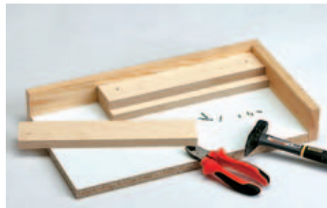
4 Die Spannbacke besteht aus insgesamt vier Multiplex-Streifen. Damit die Hölzer beim Verpressen nicht verrutschen, ...
