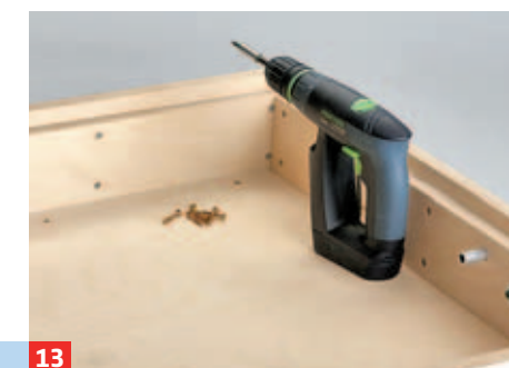
13 Den Schleif-Aufsatz schrauben Sie (nach Vorbohren und Senken) auf die vordere und hintere Auflagerleiste.
