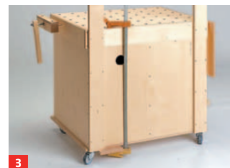
3 ... Haltern verschrauben. Dann die senkrechten Streben zuschneiden, bohren/senken und an den Korpus schrauben.
