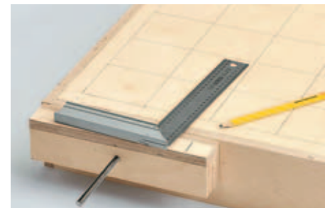
18 Übertragen Sie die erste und dritte Rasterlinie mit einem Winkel auf die Spannbacke.
