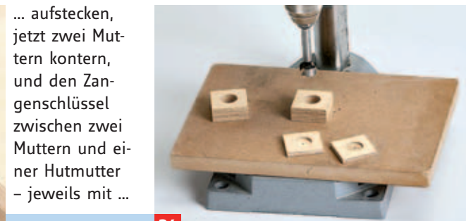
24 ... Scheiben fest verpressen*. Bohren Sie nun die Spannklötzchen (verschiedene Dicken) der Bankhaken an.
