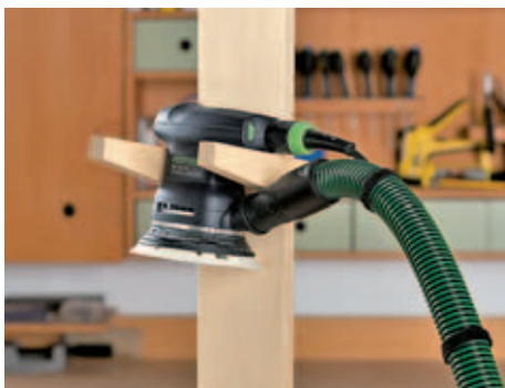
DETAIL 1: Als Parkplatz für den kleinen Exzenterschleifer haben wir zwei Hölzer seitlich an die Galgenstrebe geschraubt.
