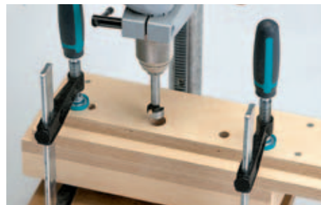
8 ... komplett durchbohrt werden, auf der Spannbacke soll sich nur die Zentrierspitze des Forstnerbohrers abzeichnen.
