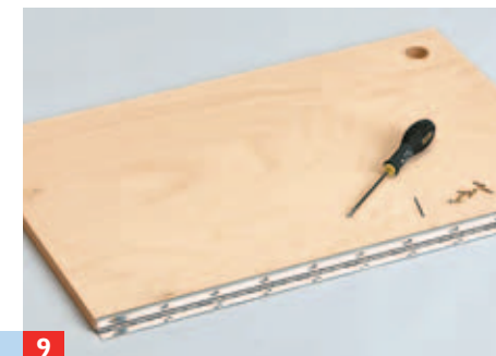
9 Stangenscharnier mit Senkkopfschrauben an den Türkanten fixieren (vorbohren!) und an den Seitenwänden anschlagen.
