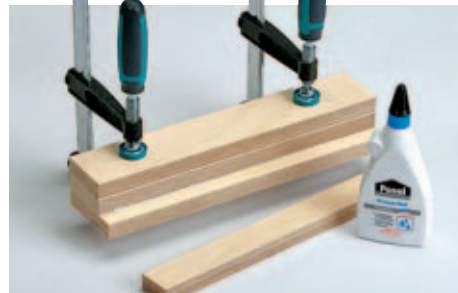
5 ... feine Drahtstifte in die Flächen schlagen und abknöpfen. Dann drei Schichten aufeinander und das obere Holz quer ...
