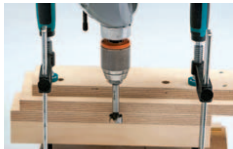
7 Anschließend die Bohrtiefe für die Rampamuffe (Bild 10) mit dem 15-mm-Forstnerbohrer einstellen: Die Zarge muss ...
