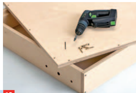
13 Von unten die gebohrte/gesenkte Bodenplatte einlegen und verschrauben. Die Zargen im Kerndurchmesser vorbohren!
