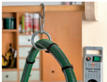
DETAIL 2: Schlauch durch den Ring führen, Anschlusskabel des Exzenterschleifers mit Klettband am Schlauch befestigen.
