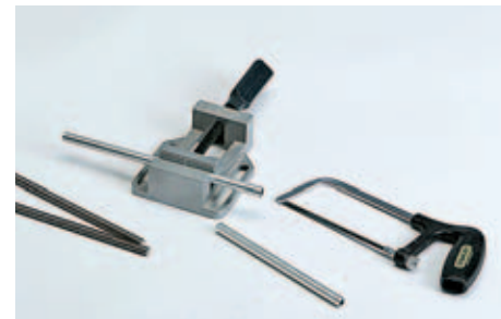
14 Längen Sie nun die Aluminium-Führungsrohre und die M10-Gewindestange mit einer Eisensäge sauber ab.
