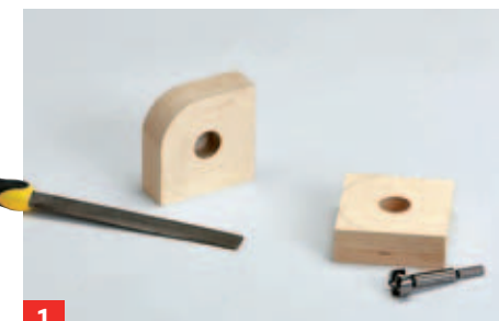
1 Die Galgenstangen-Halter bestehen aus aufgedoppeltem Multiplex. Die jeweils innere Platte durchbohren, dann die ...
