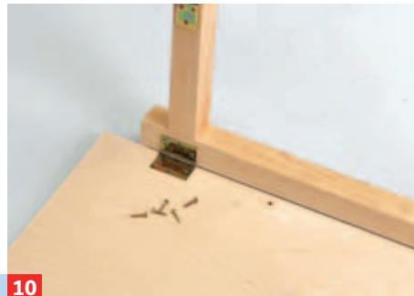
10 Im Anschluss schlagen Sie am oberen (kurzen) Rahmenteil die Klapp-tisch-Platte mit Bändern an.
