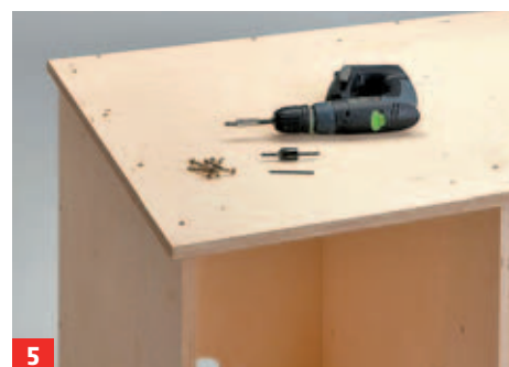
5 Dann schrauben Sie die Bodenplatte auf – sie steht seitlich und vorn über.
