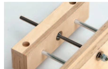
22 ... kontern. Vor der Zarge zwei Muttern kontern, dann Karosseriescheibe aufstecken. Vor der Backe eine Scheibe ...
