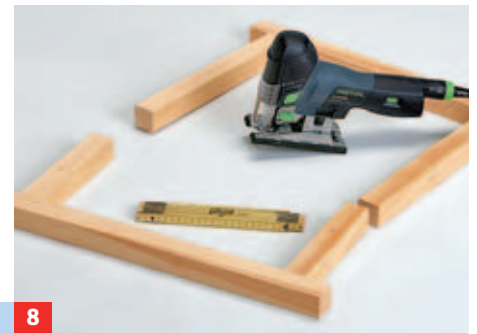
8 Nach dem Trocknen des Leims schneiden Sie den Rahmen mit der Stichsäge oder einer Feinsäge sauber auf.
