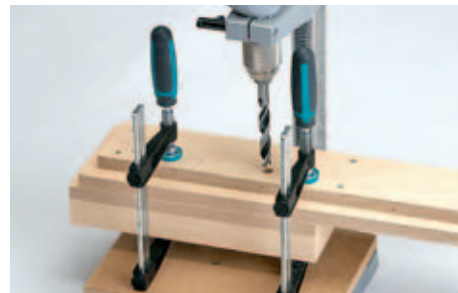
6 ... dazu verleimen. Tischzarge und Backe aufeinander zwingen und die Löcher für die Führungsrohre bohren.
