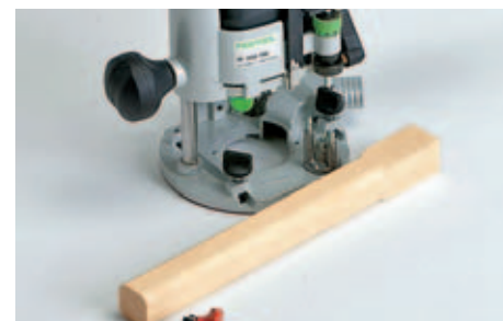
20 Mit dem Abrundfräser fertigen Sie aus einem Kiefer-Quadratstab den Zangenschlüssel. Zum Schluss durchbohren!
