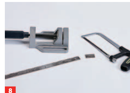
8 Längen Sie das Stangenscharnier mit der Eisensäge ab, und entfernen Sie den Grat mit einer Flachfeile.
