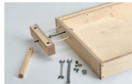
21 Spannbacke montieren: Im Tischkasten eine Karosseriescheibe auf die Gewindestange schieben, zwei Muttern am Ende ...
