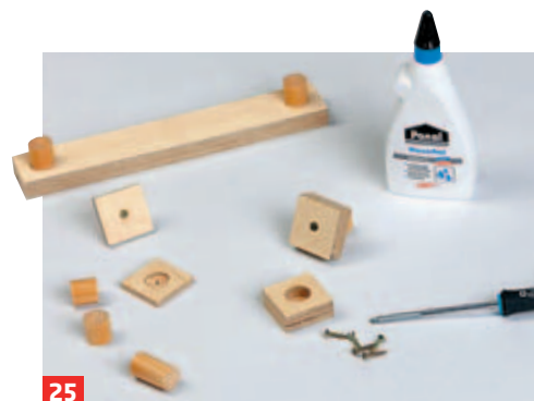
25 Die Rundholzstummel einleimen und von oben verschrauben. Auch Doppel-Bankhaken (oben) sind sinnvoll!
