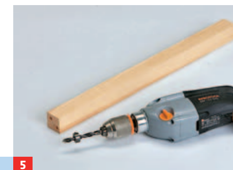
5 Das Klapptisch-Gestell wird verdübelt: hierzu Dübellöcher in die Köpfe der waagerechten Rahmenhölzer bohren.
