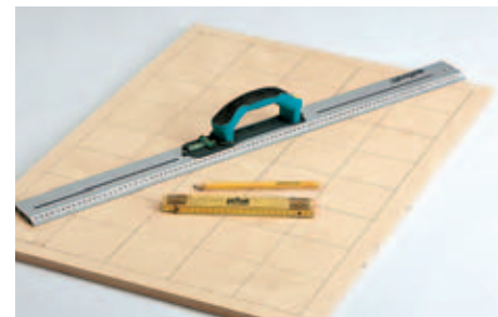
17 Zeichnen Sie dann das Lochraster auf die Arbeitsplatte. Legen Sie diese anschließend provisorisch in den Zargenfalz.
