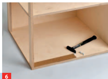
6 Bringen Sie nun – am besten wie hier bei auf die Seite gelegtem Korpus – die Nagel-Bodenträger in gewünschter Höhe an.
