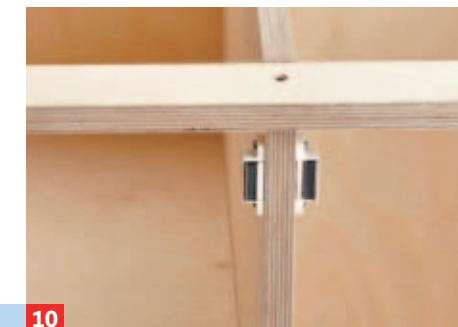
10 Magnetschnäpper an der Zwischenwand montieren und die Gegenplättchen innen an den Türen festschrauben.
