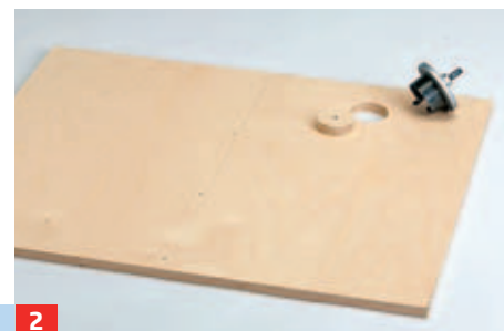
2 In die Rückwand oben rechts ein Loch für den Staubsaugerschlauch und die Anschlusskabel schneiden.
