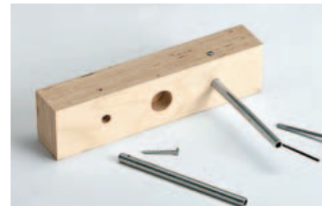
15 Alurohre in die Spannbacke stecken, von unten hineinbohren und mit Rundkopfschrauben fixieren.
