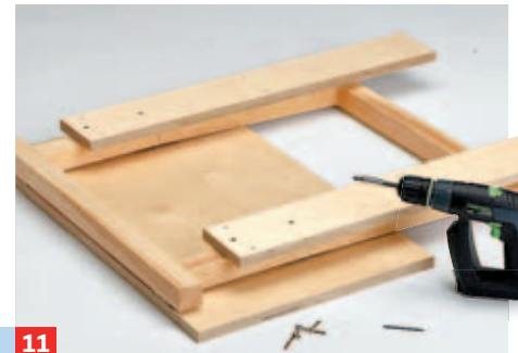
11 Hinter die senkrechten Teile des oberen Rahmens schrauben Sie dann je einen Aufdoppelungs-Streifen aus Multiplex.
