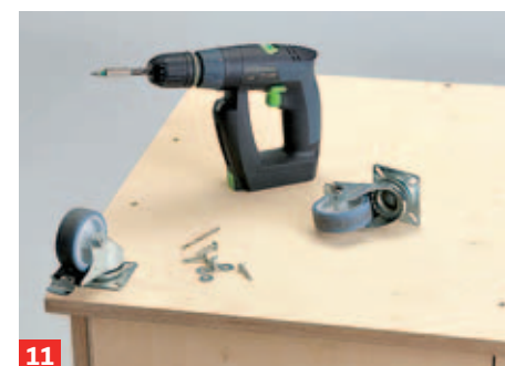
11 Mit Schlüsselschrauben befestigen Sie dann die vier Feststell-Lenkrollen unter der Bodenplatte.
