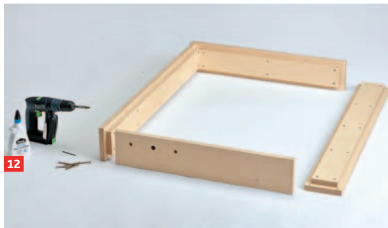
Jetzt die vier Zargen-Elemente miteinander verschrauben und verleimen.
