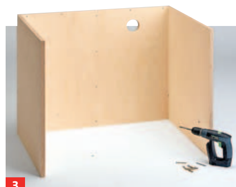
3 Leim an die seitlichen Kanten der Rückwand geben und die Seitenwände festschrauben. Im Kerndurchmesser vorbohren.
