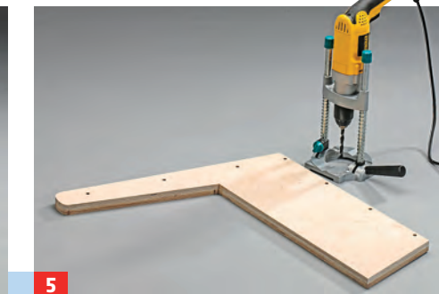
2 Sitz und Lehne aus 18er Material zuschneiden. Dann seitlich 8-mm-Dübellöcher einbringen.
