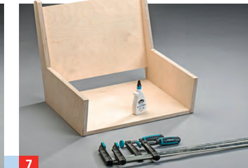
7 ... Leim in die Bohrungen und an die Stoßflächen geben, Dübel einstecken, Bauteile zusammenstecken und pressen.
