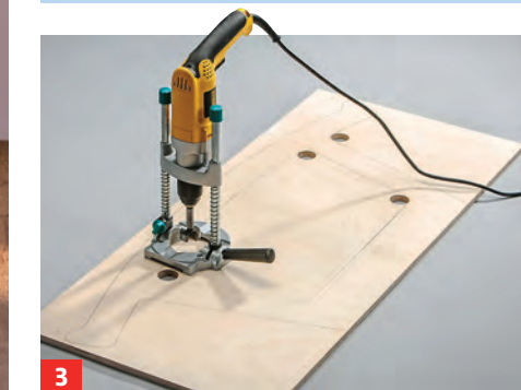
3 Die vier Innen- und die beiden Außenradien schneiden Sie exakt mit der Bohrmaschine und dem Forstnerbohrer.
