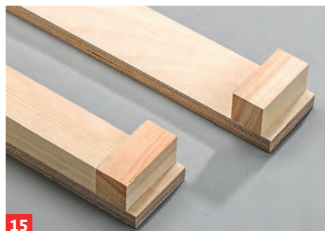
15 Diese beiden Typen von Streben gibt es: Der untere Typ wird zweimal für außen benötigt, der obere einmal für innen.
