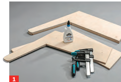
17 Mit insgesamt sechs kurzen Leimzwingen können Sie alle Bauteile miteinander verpressen. Am besten über Nacht trocknen lassen.
