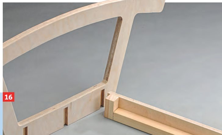
13 Danach werden die Querstreben vorbereitet. Auf alle drei Multiplex-Leisten wird an beiden Enden je ein Holzklotz geleimt.
