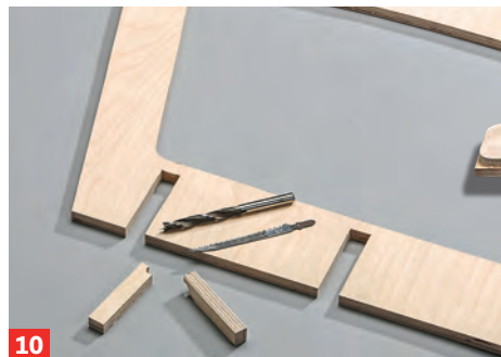
7 Nach dem Grobzuschnitt mit der Stichsäge fixieren Sie das „fertige“ Seitenteil auf dem übergroßen Halbzeug (z. B. mit ...
