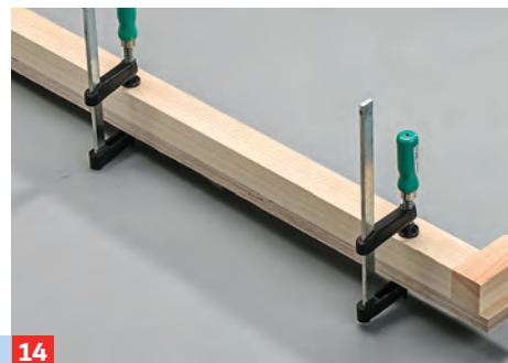
11 Anschließend leimen Sie sie jeweils gegen einen weiteren Grobzuschnitt, um ihn anschließend ebenfalls bündig zu fräsen.
