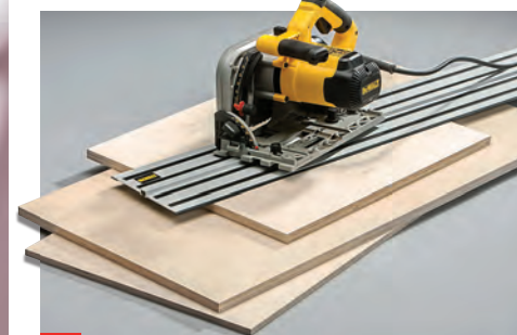
1 Drei Verbindungsstreben exakt und vier Kufenteile mit Übermaß zuschneiden – am besten mit Handkreissäge und Schiene.
