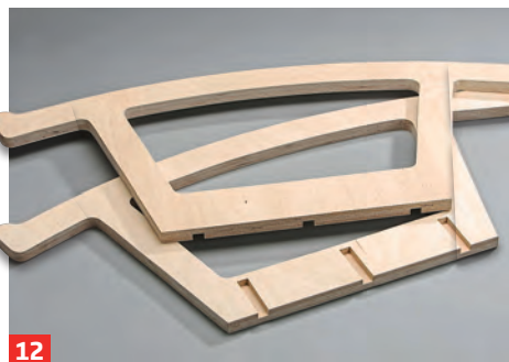
10 Klinken Sie die Bauteile im Bereich der Sitzauflage je dreimal für die Querstreben aus.
