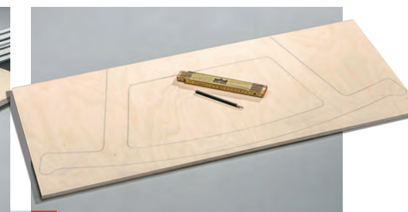
2 Zeichnen Sie die Kontur der Kufen auf die erste Platte – die Schablone hierzu finden Sie auf dem Bauplan.
