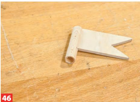
**46** Für die Dächer erhalten die Fahnenstangen zusätzlich eine Sackbohrung, um die Klebefläche zur Turmspitze zu vergrößern.
