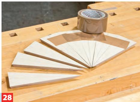
**28** Nun werden die „Tortenstücke“ exakt zusammengelegt und mit Klebeband von außen fixiert.
