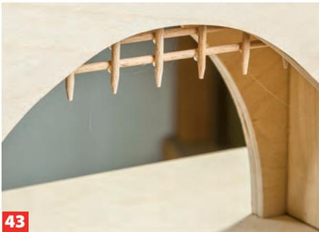
**43** Dünne, angespitzte Dübelstangen zum Gittertor-Streifen verkleben und von innen gegen das Portal heften.
