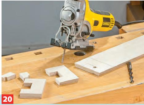
**20** Jetzt schneiden Sie die Bauteile der beiden Zinnengänge zu. Zinne für Zinne aus einem beidseitig schräg zugeschnittenen ...
