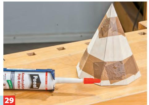
**29** Umdrehen, Kleber angeben, zusammenfügen und aufstellen. Da der Klebstoff leicht drückt, noch fest mit Klebeband umwickeln!
