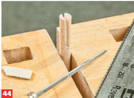
**44** Fahnen werden für die Turmspitzen und als „Anflugstangen“ benötigt: Dübelstangen schlitzeln, Sperrholzfähnchen zuschneiden ...
