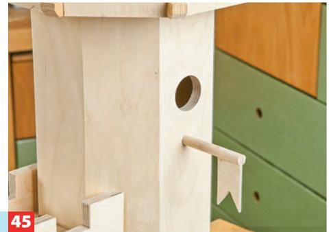
**45** ... und einkleben, anschließend in die Sacklochbohrungen unter den Nist-Einfluglöchern kleben.
