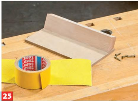
**25** ... Basis aus arbeiten. Zum Begradigen der Schnittkanten haben wir eine 21°-Winkel-Schleiflade gebaut.
