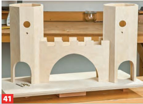
**41** Den Rohbau auf der Platte zentrieren, Konturen aufzeichnen, von unten vorbohren und senken, dann verkleben und verschrauben.
