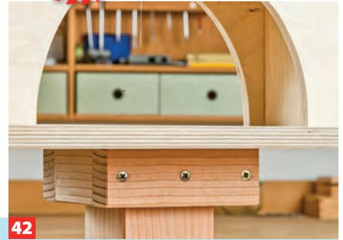
**42** Der im Boden verankerte Pfosten selbst wird später nur in die Aufnahme gesteckt und mit seitlichen Schrauben gesichert.
