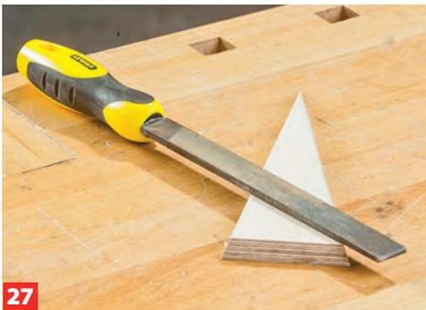
**27** Auch die Basis muss nach innen leicht abgeschragt werden. Eine Vorab-Bearbeitung mit der Feile ist zunächst ausreichend.
