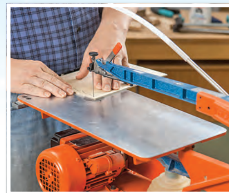
14 ... ein Loch hinein, führen das Laubsägeblatt hindurch und schneiden die Wände aus. Einfacher geht's mit der Dekupiersäge.
