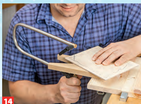
14 ... ein Loch hinein, führen das Laubsägeblatt hindurch und schneiden die Wände aus. Einfacher geht's mit der Dekupiersäge.
