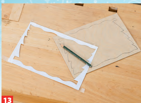
13 Zeichnen Sie jetzt die Durchbrüche der Drehteller-Wandebenen je viermal auf die zugeschnittenen Sperrhölzer, bohren ...
