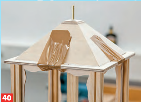
37 Nun den Deckel für den Pyramidenstumpf – tendenziell eher etwas zu groß als zu klein – zuschneiden und anschließend ...
