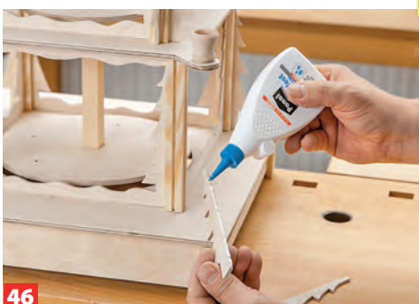
43 Für die selbstgebaute Flügelnabe acht, für die gekaufte zwölf Flügel zuschneiden. Flügel und Flügelhalter gerade verleimen.
