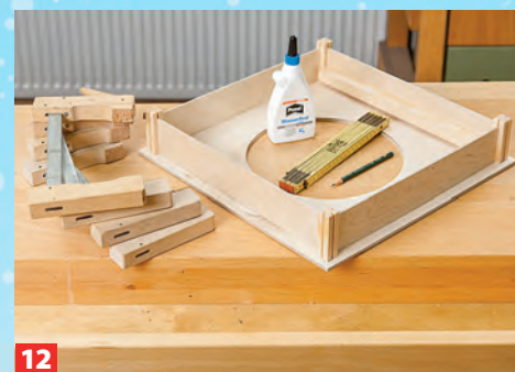
9 Anschließend die Füße mit den vorbereiteten Wänden verleimen – den Leim hierzu wohl dosiert in die Nut geben.
