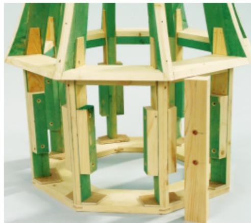
**10** So geht's rund: auf acht Schubladenrollen, die mit dem 15-mm-Forstner-Bohrer im Kopfring 5 mm tief eingelassen sind, und um eine Gewindestangenachse, die in einem Schaft aus Kupferrohr gehalten wird
