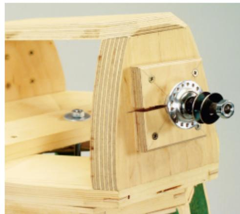
**11** Schneiden Sie die Teile der Halterung des kleinen Rotors zu. Mit dem 20-mm-Forstnerbohrer ein Sackloch in den Lagerbock bohren, in dem das kurze Ende der Achse verschwindet. Diese wird so vorbereitet ...
