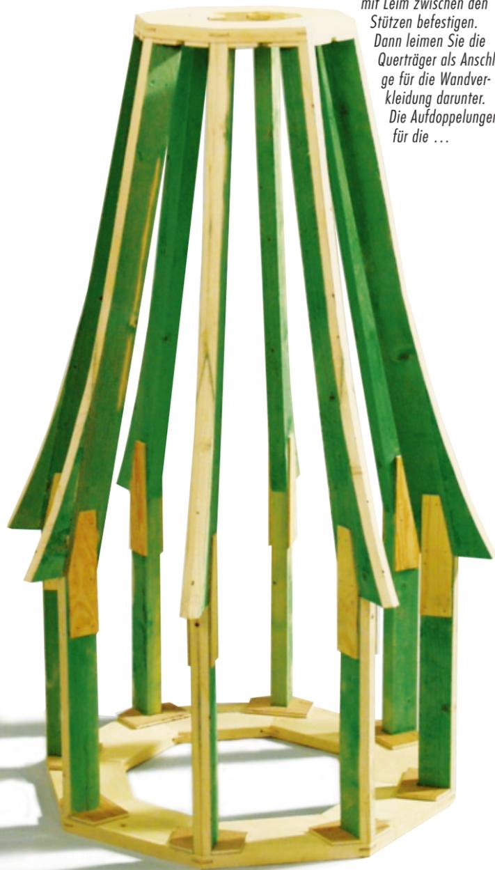
**7** ... Galerie-träger werden mit Schrauben unterhalb der Verbindungslaschen befestigt. Bereiten Sie nun die Bohrlehre vor, mit deren Hilfe Sie später (siehe Bild 14) die Löcher für die Galerie-träger setzen
