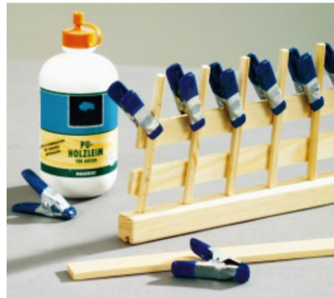
**18** ... einleimen und die Längsleisten – eine nach der anderen – mit wasserfestem Leim anklammern. Und so sieht der Flügelschwung aus, den wir mit Hilfe unseres Umleimer-Unterlegtricks geschafft haben
