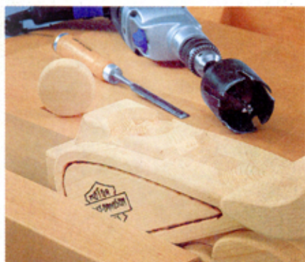
7 Eine Lochsäge schneidet die Kreiskontur für den Tankdeckel. Das überflüssige Leimholz wird mit einem Stechbeitel herausgearbeitet
