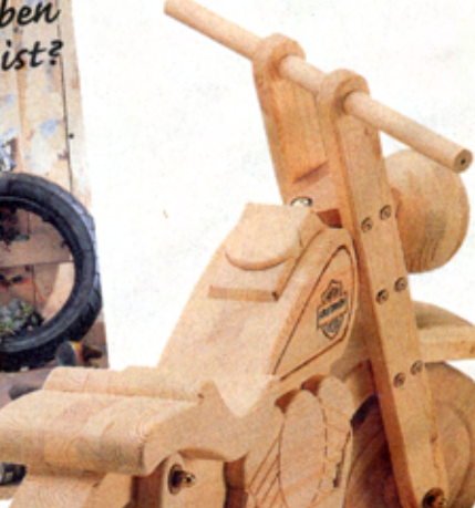
6 Auch die Aufdoppelungen werden flächig und konturgerecht verleimt. Restholzstücke als Zulagen schützen die Material-Oberflächen
