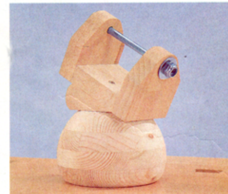
2 Das komplette Lenklager mit Lagerböcken, Distanzteilen und Trägerplatte. Die Lampe wird von hinten mit der Trägerplatte verschraubt
