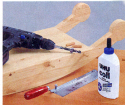
3 Zusätzlich verstärken vier eingeleimte Holzdübel je Seite die Verbindung zwischen den beiden Kufen und der Bodenplatte
