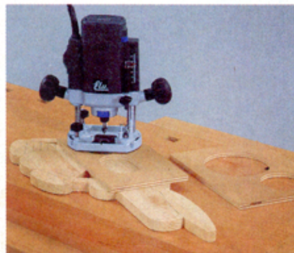
4 ... Stichsäge gehört zum Tisch. Die Konturen der Einzelteile entstehen mit Oberfräse und V-Nutfräser (wichtig ist ein Tiefenanschlag!)
