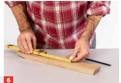
6 Anschließend werden entlang der Mittelachse (bei vier der acht Bauteile) die Löcher für die Höhenverstellung aufgerissen.
