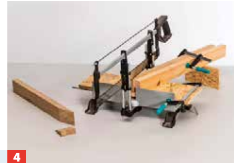
4 Fixieren Sie die Lehre auf der Säge und stützen Sie sie zusätzlich vorne ab. Die Eichenholzstreifen festspannen und zuschneiden.
