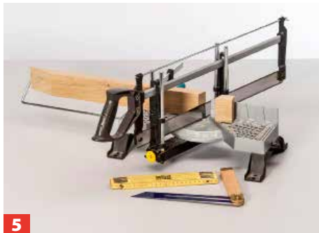
5 Sind alle acht Hölzer derart zugeschnitten, schneiden Sie sie auf Länge. Der Schnitt an der Basis erfolgt im 20°-Winkel!
