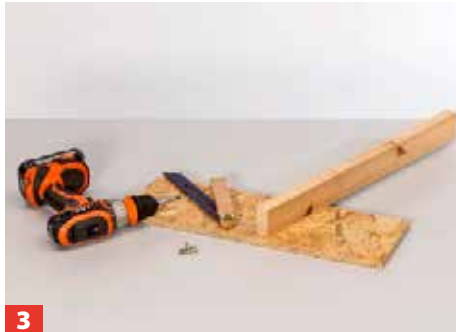
3 Um die 110°-Winkel mit der Präzisions-Gehrungssäge zuschneiden zu können, müssen Sie eine solche Schneidlehre herstellen.
