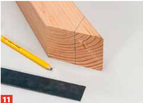
... im 45°-Winkel aufschneiden. Markieren Sie auf der Diagonalstrebe die optimale Schraubenposition auf der Mitte der ...
