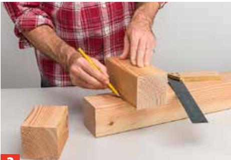
**3** ... der Querträger. Hier liegen sie 90 mm unter dem Ende der Stützen, da auf die Querträger weitere Balken montiert werden!
