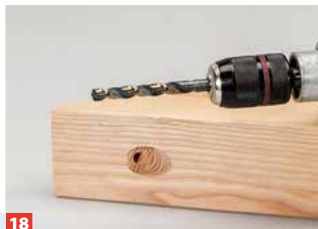
Die Durchgangsbohrung für die Schraube erfolgt dann mit einem Spiralbohrer. Nur eine Seite der Streben wird so gebohrt!
