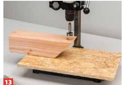
Winkeln Sie den Anriss auf die spitze Schablonenholz-Fläche. Der Bohrpunkt des Forstnerbohrers (im Durchmesser der ...
