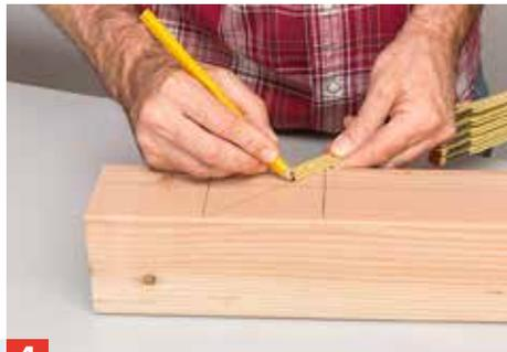
**4** Querträger und Balken werden mit jeweils zwei durchgehenden Schlossschrauben verbunden. Markieren Sie auf der Diagonalen ...
