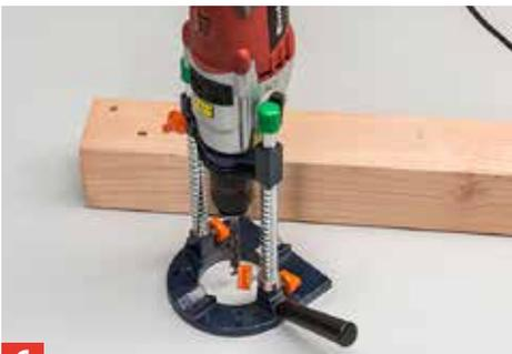
**6** Verwenden Sie einen Bohrständler! An den Markierungen des unteren Balkens setzen Sie den Bohrer erneut an und durchbohren ihn.
