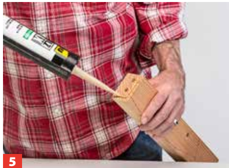
5 Die einzelnen Bauteile werden danach mit wasserfestem Holzklebstoff verklebt. Geben Sie den Kartuschenkleber an, ...
