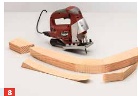
8 Mit der Stichsäge schneiden Sie die Rundungen nun sorgfältig zu und längen anschließend den vorderen Steven exakt ab.
