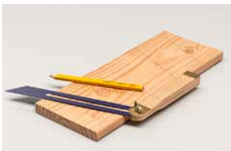
12 Mit einer Schmiege übertragen Sie nun die Schrägschnitte sowie die Überblattung auf das Basis- und die jeweiligen Seitenbretter.
