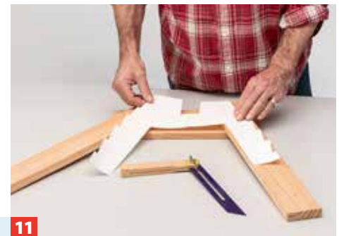
11 ... Sie aus Douglasien-Glattkantbrettern die Bauteile für die Spanten (hier der vordere Spant). Die Bretter überlappen einander!
