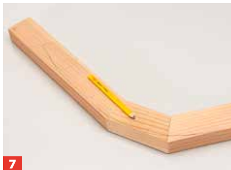
7 Nach dem vollständigen Abbinden reißen Sie auf dem Balkenkiel die äußere Rundung an. Die Ecken innen bleiben eckig.
