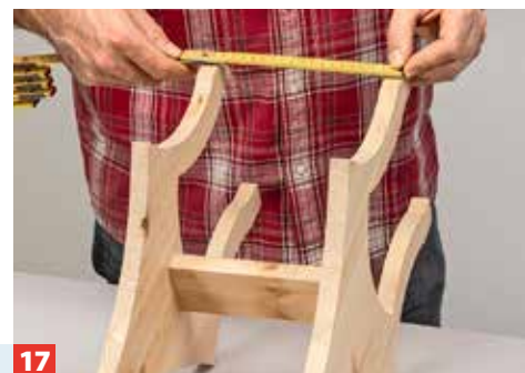
17 Überprüfen Sie noch einmal die Tiefe des Hauses, um die Mindestlänge der Wand- leisten zu bestimmen.
