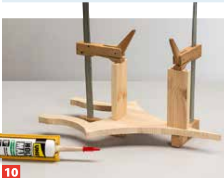
10 Mit wasserfestem Holzklebstoff aus der Kartusche und eingesetzten Dübeln verkle- ben Sie dann die Verbinder auf der Wand.
