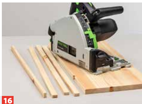
16 Nun schneiden Sie mit der Handkreissäge aus Leimholz 10 mm breite Holzstreifen für die Wände zu. Alternativ Fertigeleisten verwenden.
