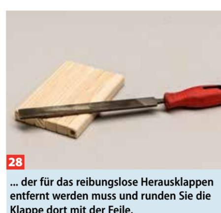
**28** ... der für das reibungslose Herausklappen entfernt werden muss und runden Sie die Klappe dort mit der Feile.
