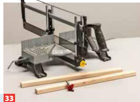
**33** Jetzt längen Sie die Leisten für die Rumpfsseiten ab. Auch diese Bauteile werden rundum gefast!
