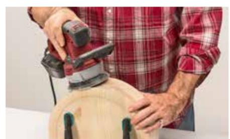
**8** Spannen Sie die Platten mit gleichem Maß jeweils zusammen und schleifen Sie die Konturen mit dem Exzentrerschleifer bündig.
