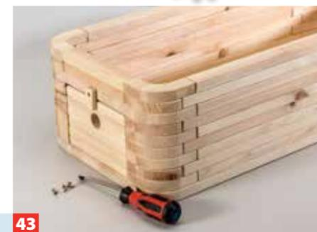
**43** Der Drehriegel wird oben mittig über der Klappe mit einer Schraube angeschlagen.
