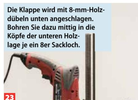
Die Klappe wird mit 8-mm-Holzdübeln unten angeschlagen. Bohren Sie dazu mittig in die Köpfe der unteren Holzlage je ein 8er Sackloch.
