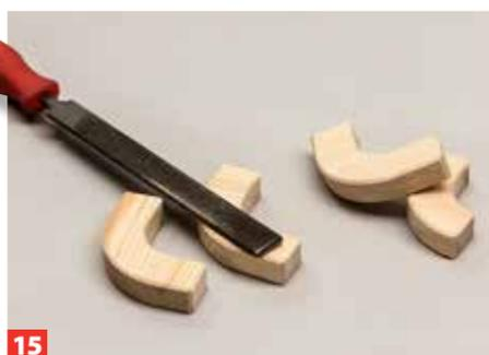
**15** Nach achtern müssen die Eckstücke bündig enden, da hier eine Klappe eingesetzt wird. Nach dem Ausschneiden die Bauteile fassen.
