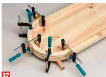
**37** Das funktioniert genauso bei den Bögen am Bug. Denken Sie daran: immer abwechselnd lange und kurze Bauteile verleimen.
