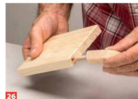
**26** Die Dübel einsetzen und Klappe und Ecken zusammenstecken. Die Dübel sitzen stramm in der Klappe und drehbar in den Eckteilen.
