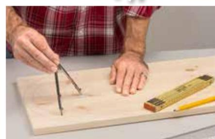
**1** Beginnen Sie mit der Bodenplatte des Schiffs: Zeichnen Sie die Form auf eine ausreichend große Platte 18-mm-Kiefer-Leimholz.
