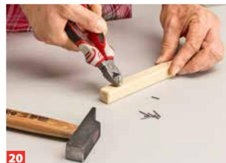
**20** Schlagen Sie kleine Drahtstifte in die späteren Leimflächen und kneifen Sie die Drähte knapp mit dem Seitenschneider ab.
