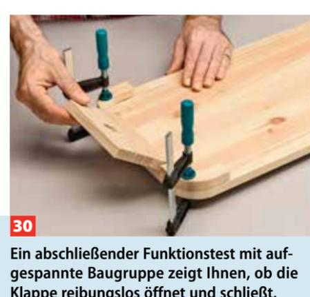
**30** Ein abschließender Funktionstest mit aufgespannter Baugruppe zeigt Ihnen, ob die Klappe reibungslos öffnet und schließt.
