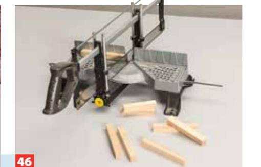
**46** Das Ruderhaus wird aus 18-x-18-mm-Quadratleisten gebaut. Die Leisten können Sie aus Leimholz zuschneiden und mit der ...
