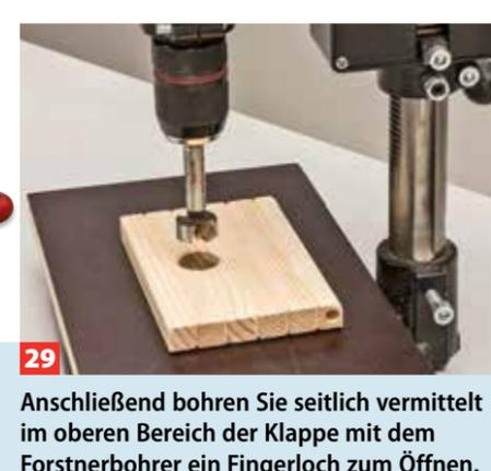
**29** Anschließend bohren Sie seitlich vermittelt im oberen Bereich der Klappe mit dem Forstnerbohrer ein Fingerloch zum Öffnen.
