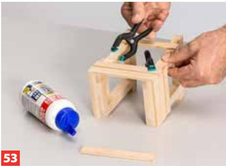
**53** Nach dem Abbinden werden die Seiten mit Querleisten an der Vorderseite (drei Leisten unten, eine oben) verbunden.
