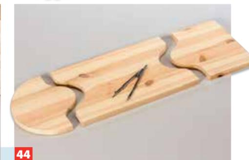
**44** Nun schneiden Sie das Deck zu. Rundum sollten etwa ein bis zwei Millimeter Luft verbleiben. Das Deck ist dreigeteilt.
