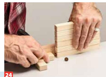
**24** Übertragen Sie die Bohrungen mit Dübel-Markierstiften auf die Eckbögen. Führen Sie die Teile außen bündig kräftig zusammen.
