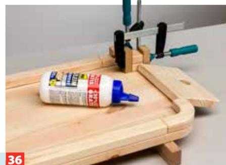
**36** ... versehen. So lassen sich die Hölzer auch bei austretendem Leim gut lösen. Teile seitlich fixieren und verpressen.
