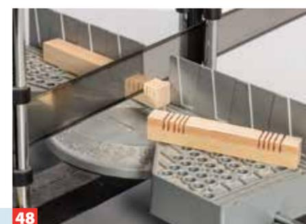
**48** Die Überblattungen bis zur halben Materialstärke einschneiden und die so ...
