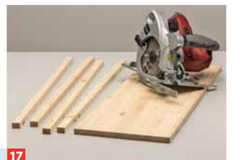
**17** Nun schneiden Sie die geraden Leisten für den Rumpf auf Breite – am besten mit einer Handkreissäge entlang einer Schiene.
