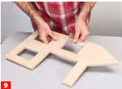
6 Die Rahmen werden stumpf gefügt. Schneiden Sie die Bauteile zu und verkleben sie mit wasserfestem Holz-Montagekleber.
