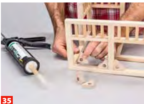
35 In die oberen rechten Winkel zwischen Querstreben und Stützen kleben Sie solche Eckverbinder aus Multiplex.
