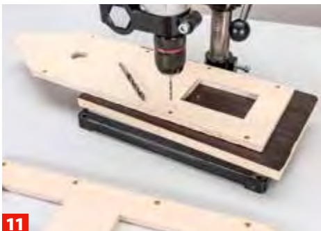
11 Damit die Schraubenköpfe später mit Dübelstopfen verdeckt werden können, bohren Sie 8-mm-Sacklöcher und ...
