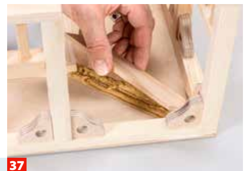
37 Unter den Stoß der beiden Dachplatten kleben Sie eine entsprechend ausgeklinkte Leiste.
