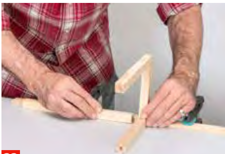
33 Die Seitenteile und die oberen Querverbinder werden verdübelt. Die Dübellöcher übertragen Sie mit Dübel-Markierstiften.
