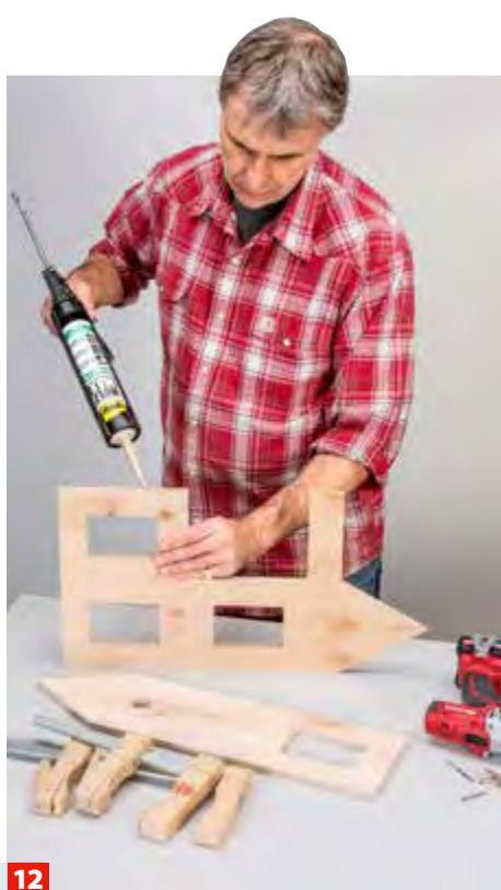
12 ... 3,5-mm-Durchgangslöcher. Zusätzlich wird die Gebäudehülle verklebt. Tragen Sie den Klebstoff auf die Stoßkante auf.
