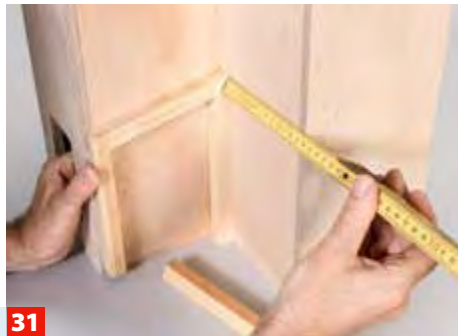
28 Die gesamte Balkenkonstruktion besteht aus Quadratstäben 18-x-18-mm. Die beiden Seitenteile des winkelförmigen Baus ...
