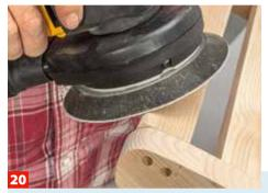
Bei der oberen Latte müssen Sie die Rundung dem Radius der Horn-Enden anpassen.
