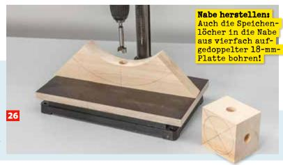
Anschließend sägen Sie den Außenradius der Felge zu. Die Nabe für die Achse mittig durchbohren und den Nabenklotz runden.
