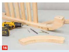
Zeichnen Sie die Montageposition an den Holmen an. Wie gehabt bohren, verkleben, und verschrauben.
