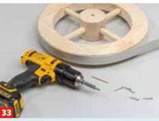
... des Profils sowie im gleichmäßigen Abstand dazwischen. Dann schrauben Sie den Felgenring auf die Holzfelge. Vorbohren!
