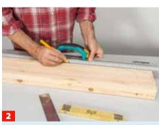
Reißen Sie die beiden Bauteile exakt auf. Die Achsseiten zeigen dabei in entgegengesetzte Richtungen nach innen.
