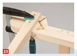
Auch die Füße stufenbohren, verkleben und verschrauben und zuletzt die Schraubenköpfe abdecken.
