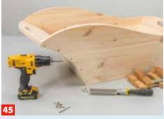
Wie zuvor die Löcher bohren; auch in die gekrümmte Wand im Schrauben-Kerndurchmesser vorbohren! Klebstoff angeben ...
