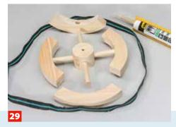
Nun den Klebstoff auch an die Speichenlöcher sowie an die Stoßkanten der Felgenteile geben, die Bauteile zusammenfügen ...
