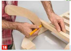
Legen Sie die überlangen Latten auf und zeichnen sie an. Berücksichtigen Sie beim Zuschnitt die Schrägen!
