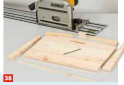
... Zwischenstück und oberen Bogen mit der Stichsäge aussägen. Basis und Seiten mit der Handkreissäge schräg zuschneiden!
