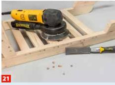
Alle Schrauben werden mit Rundstab-Abschnitten verdeckt. Die Hölzer einkleben, bündig abschneiden und beischleifen.
