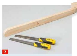
... Achse durchbohren. Die Enden der Fahrwerks-Bauteile runden Sie z. B. mit einer Raspel und einer Feile. Zuletzt schleifen.
