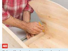
Sieben überlange (etwa 420 mm lange) Holzstreifen mit Winkelschnitt auf 40 mm Breite zuschneiden und deren Länge ...
