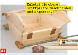
... ausrichten und anzeichnen. Nach dem Einpassen lassen sich die Leisten miteinander verkleben. Mit Paketband verpressen.
