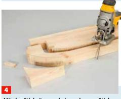
Mit der Stichsäge und einem langen Stichsägeblatt schneiden Sie nun entlang der Kontur aus. Achten Sie darauf, dass das ...
