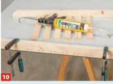
Verschrauben und verkleben Sie die Latten zunächst komplett mit einem, anschließend mit dem zweiten Holm.
