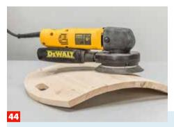
Hat der Klebstoff abgebunden, schleifen Sie die konvexe Seite mit dem Exzenterschleifer und die konkave Seite von Hand.
