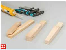
Am Übergang vom Holm zum Griff sitzen zwei Füße aus aufgedoppelten 18-mm-Hölzern, die zur Basis hin konisch abgeschrägt werden.
