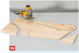
Weiter geht es mit dem Aufsatz: Seitenwände aufreißen und ausschneiden. Tipp: Eine Seite als Schablone für die zweite nutzen!
