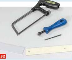
Kürzen Sie das Flachprofil auf das Umfangmaß. Bohren und senken Sie Löcher zum Verschrauben - am Anfang und am Ende ...
