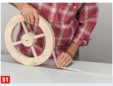
Damit ermitteln Sie den genauen Umfang. Das Klebeband abnehmen und auf ein Alu-Flachprofil kleben.
