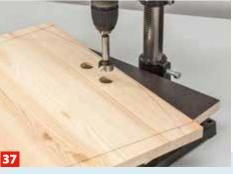
Anschließend die Rückwand inklusive dem Griff-Langloch aufreißen. Das Langloch mit einem Forstnerbohrer durchbohren, ...
