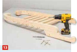
Die Griffe werden von unten mit dem Holm verschraubt und zusätzlich verklebt. Auch hier werden später Holzstopfen gesetzt!
