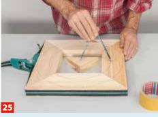
... gleiche Teile auf Gehrung zu und verspannen sie leimlos. Jetzt mit einem Mittelpunkt-Stück die Raddurchmesser aufreißen.
