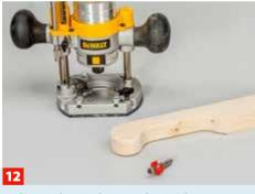
... die runden Enden mit der Stichsäge lamellenförmig ein- und ausschneiden. Den Griffbereich mit dem Abrundfräser runden.
