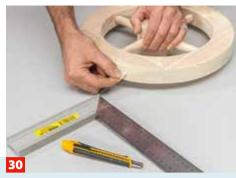
... und mit einem Spanngurt verpressen. Nach dem Trocknen kleben Sie ein glattes Krepp-Klebeband einmal um die Felge.
