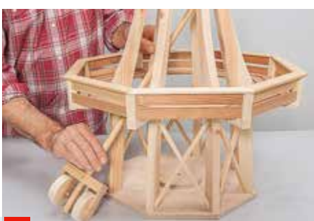
47 Fädeln Sie die Stehwelle durch das offene Sockelfach ein. Den Messingdorn in das Lager stellen und das Korbrad mittels ...
