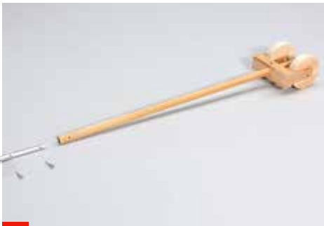
46 Nun die Glaslagerplatte mittig auf den Boden kleben und die Bauteile der Stehwelle zurechtlegen. Glaslager einlegen.
