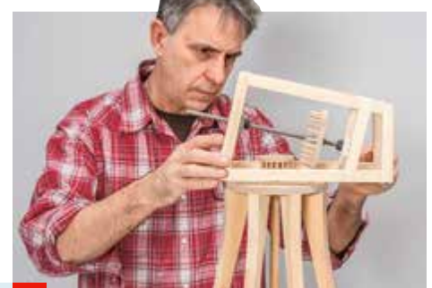
48 ... Alu-Rundstab und Schrauben fixieren. Jetzt den Mühlenkopf aufstellen, fixieren und mit der Kopfplatte verschrauben.
