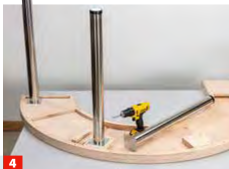
4 Zwei solcher Doppelplatten unter den Tischbeinen aufschrauben. Die dritte Platte sitzt direkt auf der Auszugsplatten-Unterseite.
