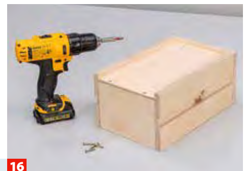
16 Zuletzt schieben Sie den Boden von der Rückseite ein und schrauben ihn mit Spanplattenschrauben auf der Rückwand fest.
