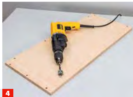
4 ... die Rückwand nicht vergessen! Anschließend die Dübellöcher oben, unten und hinten in beide Seitenwände bohren.
