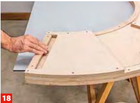
15 Damit sich das Brett auch nach der Montage der Aufdopplung verschieben lässt, müssen Sie die untere Furnierschicht abschleifen.
