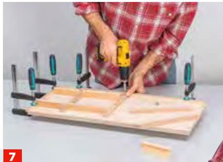
7 Mit Distanzleisten richten Sie nun die Schubkastenführungen auf beiden Seiten aus und schrauben sie fest.
