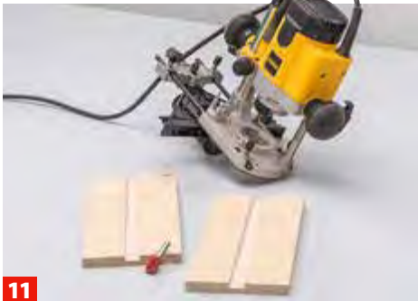
11 Nach dem Zuschnitt der Schubkastenwände werden die Seitenzargen außen für die Laufleisten mit der Oberfräse genutet.
