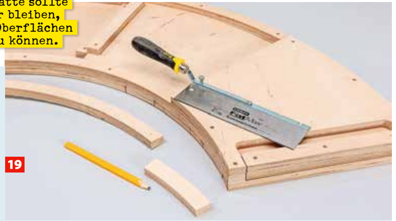
16 Fräsen und schneiden Sie den gerundeten Plattenabschluss zu und schrauben Sie ihn am Tischplattenende auf die Aufdopplung.
