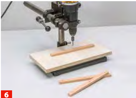
6 Bohren und senken Sie die Leisten – am besten mit der Ständerbohrmaschine. Die Schraubenköpfe dürfen nicht vorstehen.
