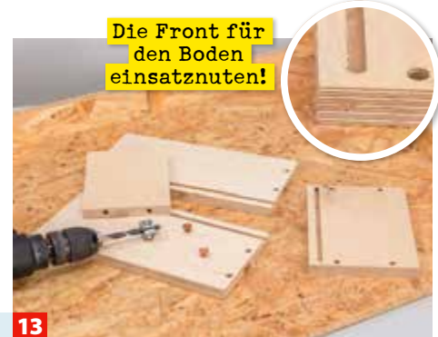
13 Dübellöcher bohren und in der Winkellade übertragen. Die niedrige Rückwand sitzt zwischen den Seitenwänden, die Front davor!
