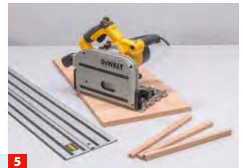
5 Vor dem Verleimen des Korpus werden die Laufleisten für die Schubkästen aus Hartholz (hier: Buche Leimholz) zugeschnitten.
