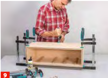
9 Mit Schraubzwingen verpressen, bis der Leim abgebunden hat. Austretenden Leim nach dem Anziehen mit einem Beitel abnehmen.
