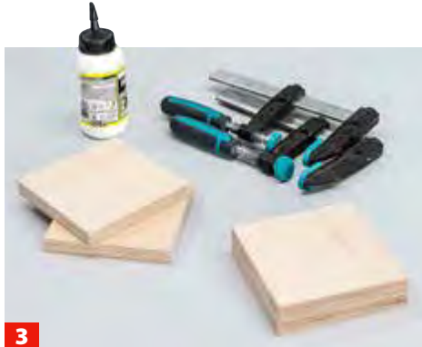
3 Zur Montage der Tischbeine in der nicht massiven Platte müssen Sie entsprechende Multiplex-Platten aufdoppeln.
