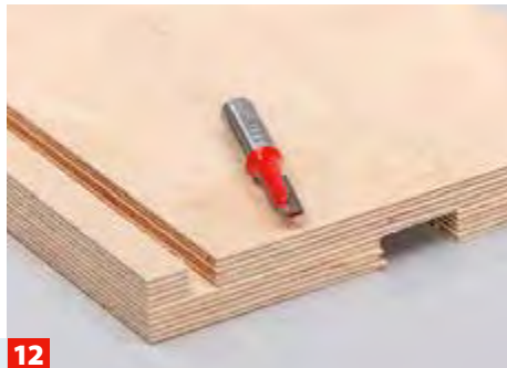
12 Innen wird anschließend eine Nut für den Boden gefräst. Die Frontplatte ebenfalls innen nuten – allerdings nicht durchnuten!
