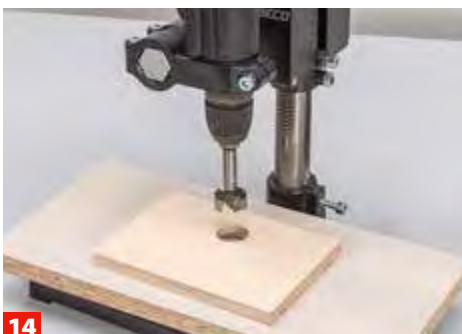
14 Mit dem Forstnerbohrer schneiden Sie ein Griffloch in die Schubkastenfronten.
