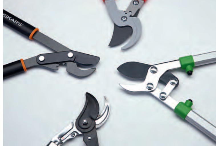
BESCHICHTET: Beschichtete Schneiden sorgen für einen leichteren Schnitt – allerdings verschleißt der Belag allmählich.
