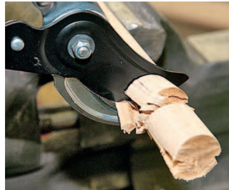
RUTSCHIG: Nach vorn gleitendes Schnittgut erschwert den Schnitt.
