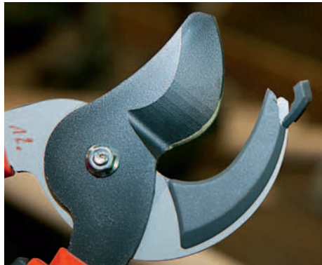
BRUCH: An der Gardena -Ambossschere brach ein Kunststoffteil beim Dübeltest.
