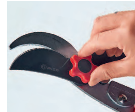
NACHSTELLBAR: Werkzeuglose Spannschraube an der Connex -Schere.
