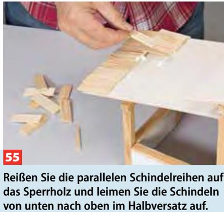
**55** Reißen Sie die parallelen Schindelreihen auf das Sperrholz und leimen Sie die Schindeln von unten nach oben im Halbversatz auf.
