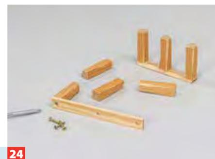
**24** ... bohren und senken, die auskragenden Balkonbalken ablängen, einen Tropfen Leim angeben und die Bauteile verschrauben.
