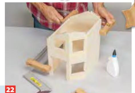
**22** Dann Leim an die Kontaktstellen geben, die Wände aufstellen, mit Klebeband fixieren und die stumpfen Leimfugen verpressen.
