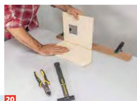
**20** Rückwand, rechte und linke Seite stoßen stumpf an und werden mithilfe des Nageltricks markiert und später verleimt.
