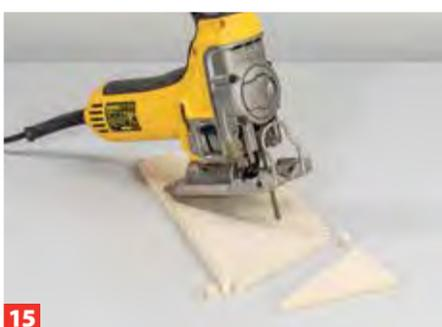
**15** Die Giebelwände – wegen des besonderen Grundrisses sind es drei – zuschneiden und für die Dachbalken ausklinken.
