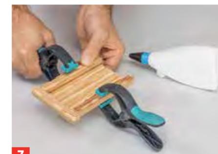
**7** Den ausgetretenen Leim entfernen und das Türblatt hinter den Rahmen leimen.
