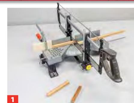
**1** Bei dieser Krippe beginnen wir ausnahmsweise einmal mit dem Bau der Fenster und Türen. Längen Sie die Rahmenbauteile ab ...
