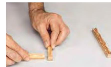
**3** Die Rahmenhölzer (hier die des unteren Türrahmens) werden stumpf verleimt. Abgekniffene Drahtstifte in der Kontaktfläche ...
