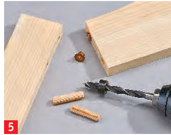
5 8-mm-Dübellöcher mit Tiefenanschlag ins Hirnholz bohren. Positionen mit Dübelfixen übertragen
