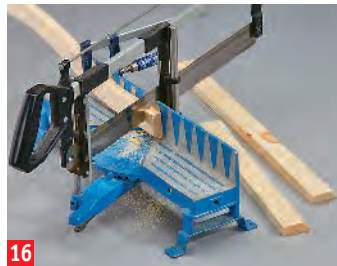
16 Prozedur für Kranzleiste (13) wiederholen. Nach dem Fräsen Kranzleisten mit der Gehrungssäge kappen
