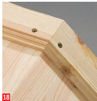
18 Die Schraubenlöcher sind vorgebohrt und angesenkt. Die Winkel der geraden Kranzleisten jeweils anpassen
