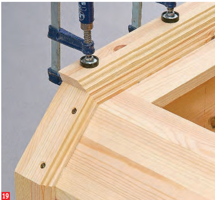
19 Die Schraubenköpfe verschwinden unter der darüber liegenden Leiste. Die beiden nächsten Lagen verleimen Sie nur. Passen Sie die Schrägen der Kranzleisten für Seiten und Frontschrägen stets erst an Ort und Stelle an
