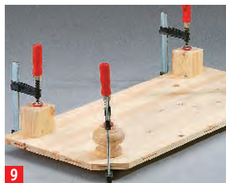
9 Dübel der Kauffüße halbieren und damit auch die selbst gebauten hinteren unter die Bodenplatte leimen
