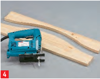
4 Schneiden Sie das obere Korpusrahmenbrett mit der Stichsäge aus. (Schablone auf dem Bauplan!)
