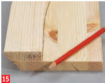
15 Nun die Kranzleiste (7) ausschneiden, auf Kranzleiste (10) positionieren und deren Oberkante markieren
