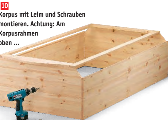
11 ... können Sie Schrauben nur seitlich platzieren! Beim Verleimen der Frontschrägen hilft festes Klebeband
