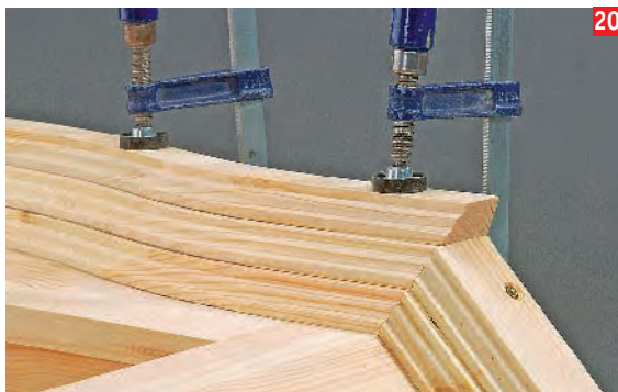
19 Die Schraubenköpfe verschwinden unter der darüber liegenden Leiste. Die beiden nächsten Lagen verleimen Sie nur. Passen Sie die Schrägen der Kranzleisten für Seiten und Frontschrägen stets erst an Ort und Stelle an
