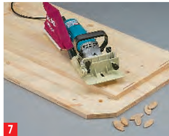
7 Für die übrigen Korpusverbindungen bringen Sie mit der Flachdübelfräse Schlitz für die Flachdübel ein
