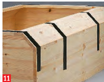
11 ... können Sie Schrauben nur seitlich platzieren! Beim Verleimen der Frontschrägen hilft festes Klebeband
