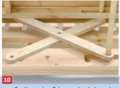
... außenliegenden Scherenschenkel werden mit Spanplattenschrauben an den zuvor markierten Stellen "mit Spiel" verschraubt
