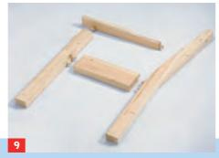
... Runddübel und Dübel-Markierstifte verwenden. Seitenteile trocken auf Passgenauigkeit prüfen, dann ...
