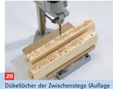
der Beplankung bzw. des Scherentischs) wie in Bild 6 gezeigt bohren
