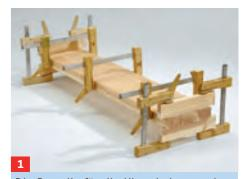
Die Bauteile für die Hinterbeine werden aus je drei Douglasienhölzern 45 x 70 mm mit wasserfestem Klebstoff aufgedoppelt
