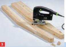
Anschließend mit der Stichsäge die hintere Kontur zuschneiden. Ausreichend langes Sägeblatt verwenden!
