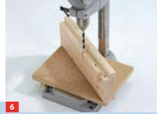
Bereits vor dem Verleimen die Dübellöcher für die spätere Beplankung bohren. Latten- und Abstandsmaß beachten!
