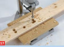
... Scherentischs auf. Diese aufzeichnen und mit dem 22er Forstnerbohrer an den im Bauplan angegebenen Punkten ...
