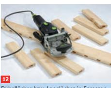
Dübellöcher bzw. Langlöcher in Sprossen und Lehnenzargen wie gehabt fräsen, ...
