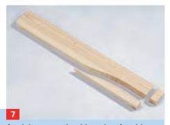
Armlehnen zuschneiden, den Anschluss an die schräge Rückenlehne mit schräggestelltem Stichsägenfuß zuschneiden
