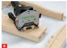
Alle Verbindungen mit der Dominofräse (8 x 40er Dübel) fräsen. Alternativ können Sie selbstverständlich auch ...
