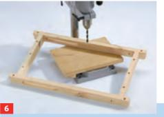
Nun werden auch in die Zarge die Dübellöcher für die Beplankung gebohrt
