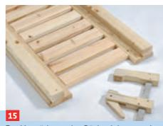
Zur Verstärkung der Rückenlehne zwei Aussteifungen aus 45-x-70-mm-Material hinter die Lehnenzargen kleben
