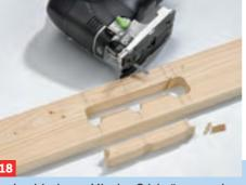
... durchbohren. Mit der Stichsäge werden die Verstellschlitze freigeschnitten
