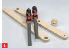
... im Bauplan angegeben fertigen (auch in den Distanzringen) und die Bauteile mit Raspel und Feile außen abrunden
