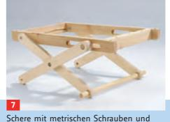
selbstsichernden Muttern beweglich montieren und mit der Zarge verbinden
