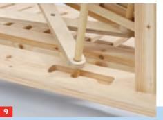
Der komplett vormontierte (hier schon beplankte) Scherentisch lässt sich schräg in die Bankzargen-Führung einfädeln, die ...
