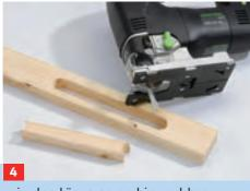
... in den Längszargen hin und her bewegen muss, müssen Sie hier zwei Führungsschlitze bohren und sägen
