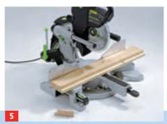
Mit der Kappsäge lassen sich die Seitenteile einfach und exakt ablängen
