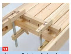
Bis zum vollständigen Trocknen fest anpressen. Getrocknete Kleberüberstände mit Stechbeitel entfernen
