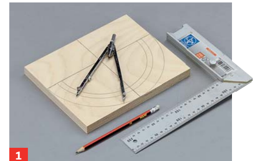
1 Die Drehplatte ist das Herzstück des Anschlags. Zeichnen Sie die Kontur und die Verstellnut exakt auf das Holz
