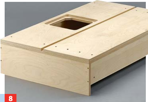
8 ... mobilen Bohrständer im Raster laut Bauplan bohren und Einschlagmuttern von unten eintreiben
