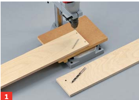
1 Bei den langen Zargen-Elementen 8-mm-Bohrungen für die Klapp-Beine, bei den kurzen gesenkte Löcher für die ...
