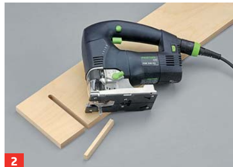
2 ... mit 10 mm durchbohren und die Schlitz dann mit der Stichsäge möglichst exakt aufschneiden. Vorritzen!
