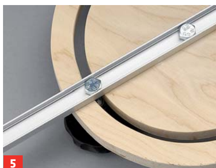
5 M8-Maschinenschrauben einsetzen, anschließend U-Profil und Drehplatte mit zwei Handrädern verbinden
