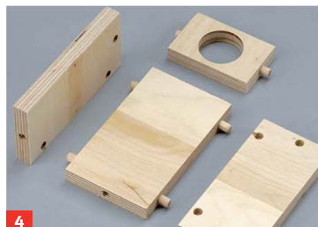
4 ... Führungsplatte einzeichnen, Dübellöcher bohren (Tiefenstopp verwenden), mit Markierstiften Positionen übertragen
