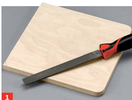
1 Grundplatte zuschneiden (umlaufend 1 mm Luft zur Aussparung im Tisch) und die Eckradien mit Stichsäge und Feile anpassen
