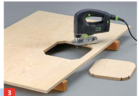
3 ... dabei mit kleinem Bohrer vorbohren. Tisch-Unterplatte und Aussparung für die Werkzeugauflage zuschneiden, ...
