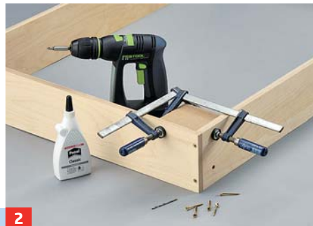
2 ... Zargenverschraubung einbringen. Mit Leim und Schrauben zusammenfügen (Montagehilfe wie im Bild verwenden), ...
