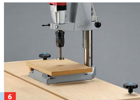
4 ... Schablone für alle weiteren Einsatzplatten verwenden. Hier im Bild eine Platte mit 35-mm-Mittelloch für die Oberfräse
