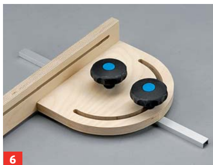
5 M8-Maschinenschrauben einsetzen, anschließend U-Profil und Drehplatte mit zwei Handrädern verbinden
