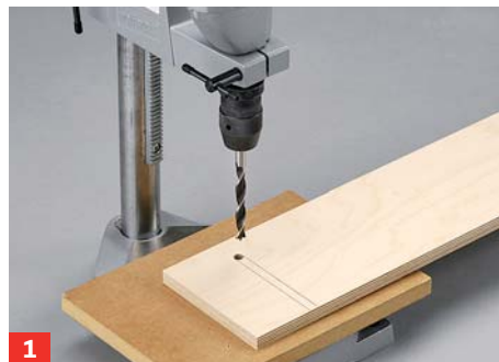
1 Die Grundplatte des Anschlags zuschneiden und die beiden Verstellslitze anzeichnen. Am Ende des Schlitzes ...
