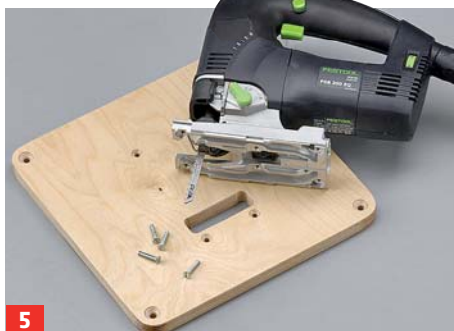
3 Durch die Bohrungen in der Platte auch die Grundplatte des Tisches markieren und durchbohren. Die erste Platte als ...
