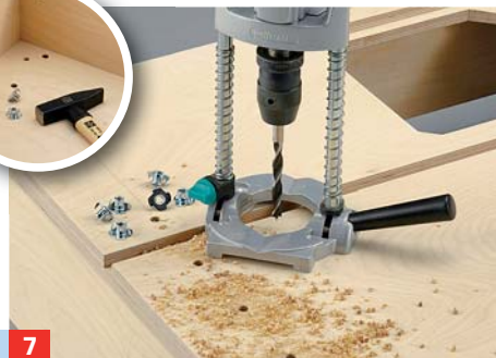
7 ... und zweite Platte ebenfalls verschrauben. Löcher für Einschlagmutter (Befestigung des Parallelanschlages) mit dem ...
