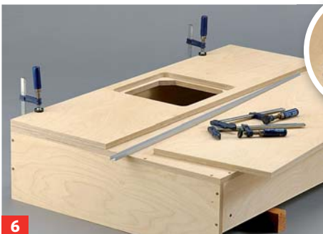
6 ... exakt ausschneiden. Erste Platte fixieren und von unten verschrauben. Alu-U-Profil als Abstandhalter verwenden ...
