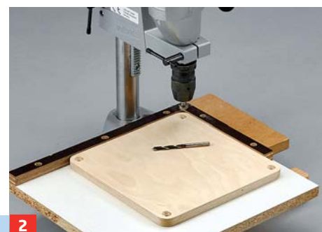
2 Bohren und senken Sie in den Ecken der Platte für die Verschraubung am Tisch
