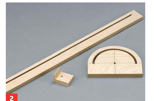
2 Nach dem Zuschnitt Schraubbohrungen und Führungsnuten bei allen Anschlagteilen fertigen. Schieber verleimen!
