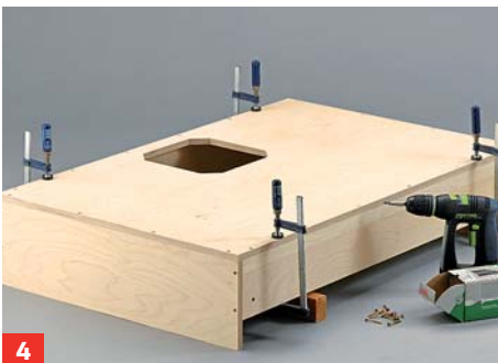
1 Bei den langen Zargen-Elementen 8-mm-Bohrungen für die Klapp-Beine, bei den kurzen gesenkte Löcher für die ...
