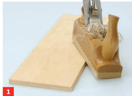
**1** Die oberen Schnittkanten des Mühlenkastens müssen mit dem Hobel nach innen um 10° angeschragt werden
