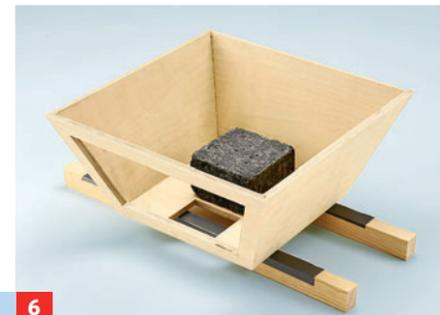
**6** ... mit Klebeband fixieren. Deckel zuschneiden, nach Klebstoffangabe einlegen und mit einem Stein beschweren
