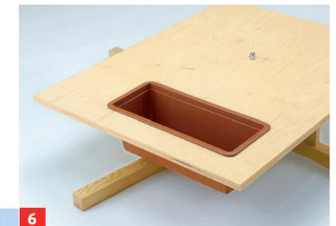
**6** Anschließend die Bodenplatte zuschneiden und mit selbstsichernder Hutmutter beweglich auf den Sockel schrauben
