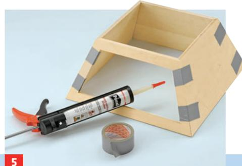
**5** ... untere Schnittkante ist wieder um 10° angeschragt. D4-Klebstoff (wasserfest) auf die Schnittkanten auftragen und ...
