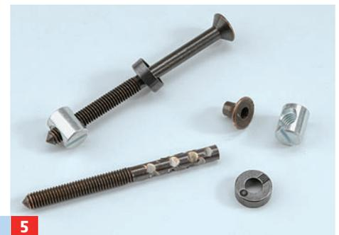
**5** Schraubenköpfe abschneiden und Schraubenhals mit Feile einkerben
