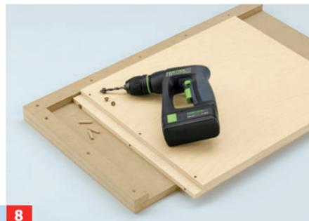
**8** Die Platten des Hauptbaukörpers werden verdübelt. Die Dübellöcher mit Markierstiften (Dübellixen) übertragen
