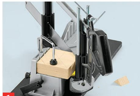
**1** Die achteckige Nabe aus aufgedoppeltem Multiplex wird auf der Gehrungssäge zugeschnitten
