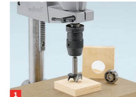
**1** Lagerschalen aus Multiplex herstellen. An der exakten Stelle (siehe Bauplan) mit dem 35er Forstnerbohrer durchbohren
