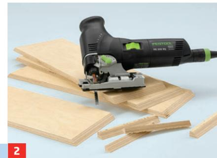
**2** Anschließend die 45°-Winkel mit der Stichsäge fertigen. Beides gelingt wesentlich einfacher mit der Tischkreissäge
