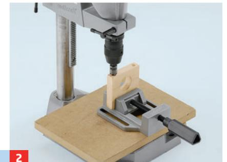
**2** Von oben den Lagerbock anbohren und senken. Zum späteren Verschrauben abgesetzte Schrauben (am Hals ohne ...
