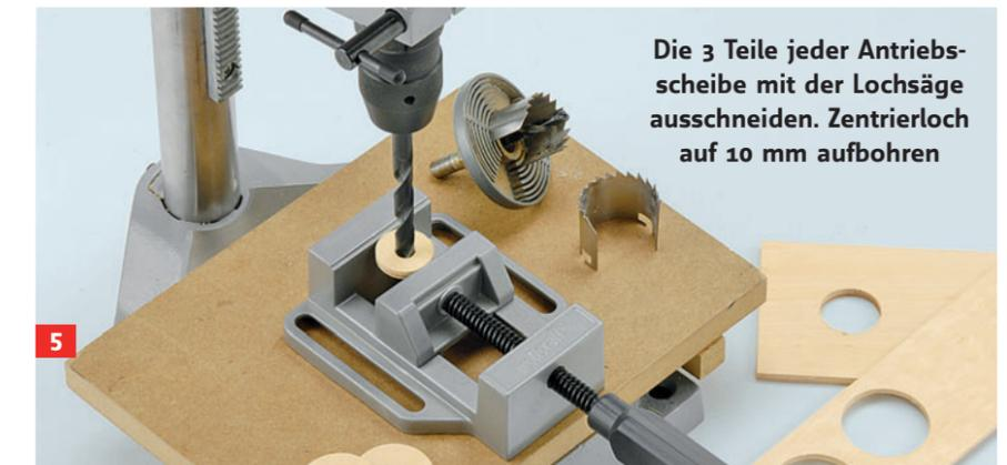
Die 3 Teile jeder Antriebs-scheibe mit der Lochsäge ausschneiden. Zentrierloch auf 10 mm aufbohren
