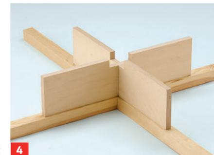
**4** ... Multiplex-Hochkant-Kreuz mit der Stichsäge zugeschnitten und von unten mit dem Bodenkreuz verschraubt.
