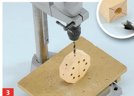
**3** ... aufbohren. Dann mit 6-mm-Bohrer in die Sacklöcher hineinbohren. Die Flügel-Vierkantleisten erhalten mittig ins ...
