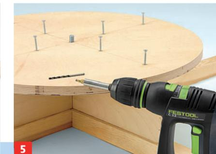
**5** Der Drehteller erhält eine Mittelbohrung für die Drehachse. M10er Schraube von unten einstecken und Bauteil aufschrauben
