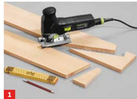
**1** Schneiden Sie zunächst die durchgehenden, äußeren Wangen aus 18-mm-Leimholz sorgfältig mit der Stichsäge zu
