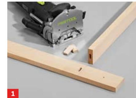
**1** Zargen zuschneiden (die hintere Zarge wird von innen gegen die Hochbett-Stützen geschraubt), Dübellöcher fräsen
