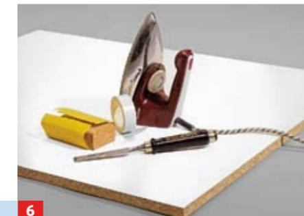
**6** Tischplattenkanten mit Schmelzkleber-Umlleimer versehen. Aufbügelnd, andrücken, überstehende Kanten mit der Seite der ...
