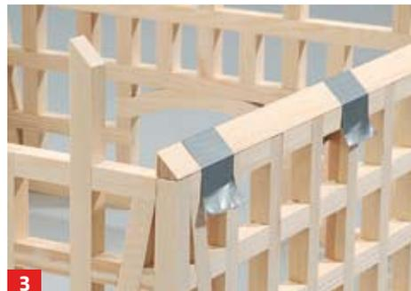
**3** Dreiecksleisten kleben Sie auf die Seitenwände und fixieren diese bis zum Abbinden mit stabilem Gewebe-Klebeband
