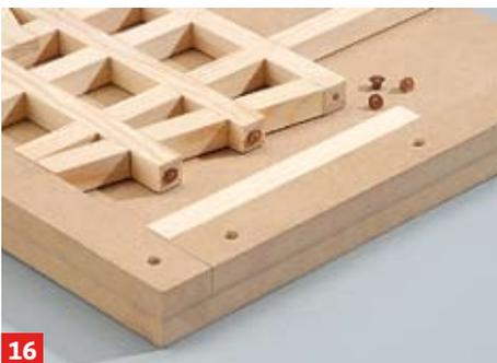
**16** Die Eckpfosten werden nun mit Holzdübeln an den Seitenwänden befestigt. Bohren Sie senkrecht in das Kopfholz der Riegel
