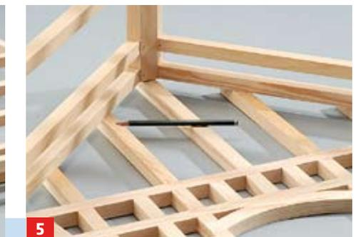
**5** Stellen Sie das komplette Dach auf die überlang gefertigten Giebel, zeichnen die Schrägen an und kürzen sie genau ein
