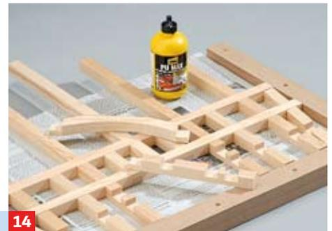
**14** In einer solchen Hilfslade, die die Winkligkeit der Wände gewährleistet, verleimen Sie die Bauteile mit PU-Kleber
