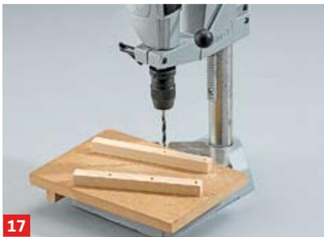
**17** Anschließend Dübel-Markierstifte einsetzen und Dübellöcher in die Marken der Eckpfosten bohren. Tiefenanschlag verwenden!
