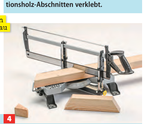
Die sechs Teilsegmente für die Felge mit der Gehrungssäge (30°-Winkel) auf Maß zuschneiden.
