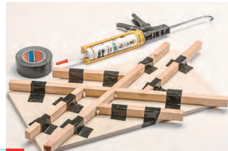
4 Wenn alles passt, Konstruktionskleber angeben und die Hölzer zusammenstecken. Mit Klebeband auf der Aufrissplatte fixieren.
