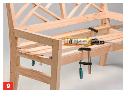
Vordere und hintere Sitzlattung ausklinken und aufkleben; die übrigen Latten mit gleichem Spaltmaß dazwischen verteilen.
