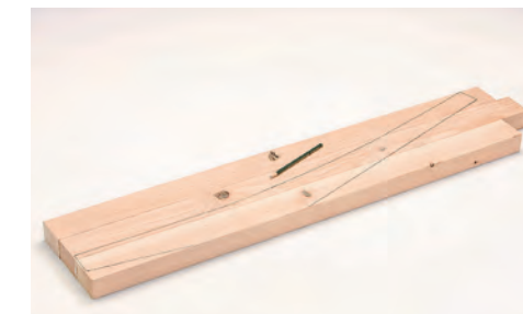
2 Entfernen Sie nach dem Trocknen den ausgetretenen Kleber und zeichnen die Kontur der Bauteile auf.
