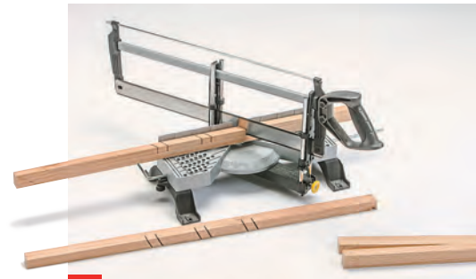
2 Schneiden Sie die Leisten im Überblattungsbereich bis zur halben Materialstärke ein (Tiefenstopp verwenden).
