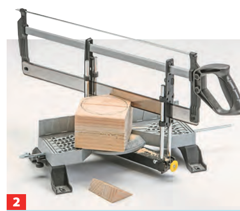
Um den Nabendurchmesser zeichnen Sie ein gleichseitiges Sechseck und schneiden dies mit der Gehrungssäge heraus.
