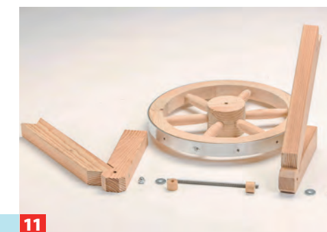
... eine Achsbohrung. Nun die Radböcke und die Distanzbuchsen herstellen, die Achse ablängen und mit Hutmuttern verschrauben.
