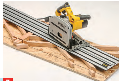
7 Die beiden horizontalen Besäum-Schnitte erfolgen über die ganze Länge mit der Handkreissäge entlang einer Schiene.
