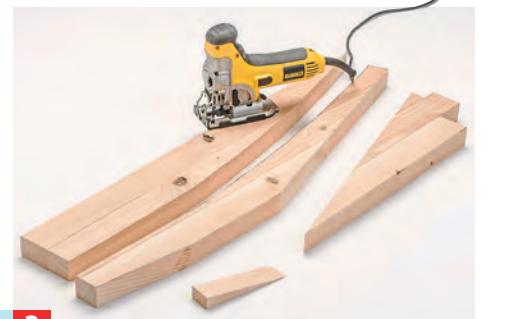
3 Mit der Stichsäge werden zwei Lehnen-teile zugeschnitten.
