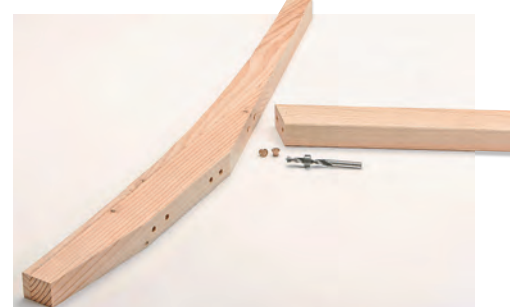
7 ... der Gehungssäge zugeschnitten und ebenfalls mit Dübellöchern versehen. Erneut mit Markierstiften übertragen und bohren.
