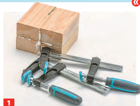
Die Radnabe ist ein massives Bauteil; der Rohling hierfür wird aus vier Konstruktionsholz-Abschnitten verklebt.
