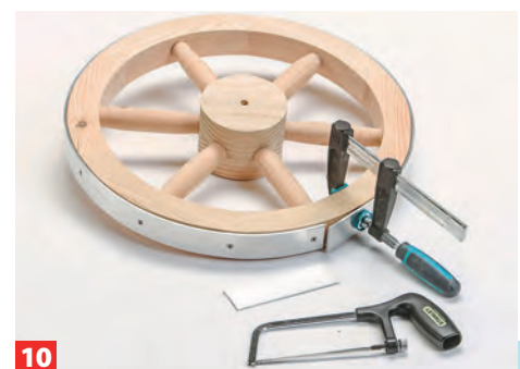
Ein Flachband aus Aluminium wird als Radlauflfläche abgelängt, gebohrt, gesenkt und aufgeschraubt. Außerdem erhält die Nabe ...
