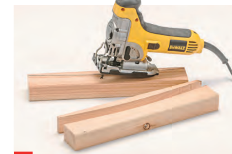
4 Jede Seite erhält drei Querholme: Der untere Holm und der konkav zugeschnittene Sitzholme liegen am geraden Segment von ...
