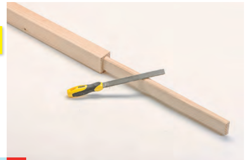
4 Die Kanten der abgesetzten Holme werden nun gerundet. Der Holmquerschnitt sollte sich dadurch jedoch nicht mehr ändern.
