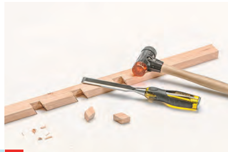
3 Mit einem scharfen Stechbeitel stechen Sie nun die Überblattung sauber aus.
