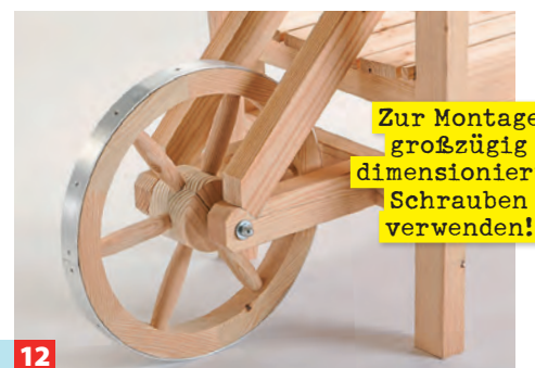
Die komplette Radeinheit wird nun von der Innenseite durch den unteren und den Armlehnenholm verschraubt. Vorbohren!
