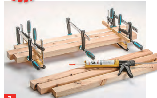
1 Mit wasserfestem Klebstoff (D4) verkleben Sie je drei Konstruktionshölzer für das Fuß/Rückenlehnen-Bauteil.
