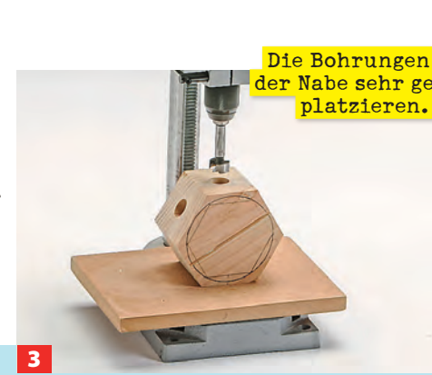
Mit der Ständerbohrmaschine wird mittig in jede Seite ein Sackloch gebohrt. Danach feilen und schleifen Sie die Kanten rund.
