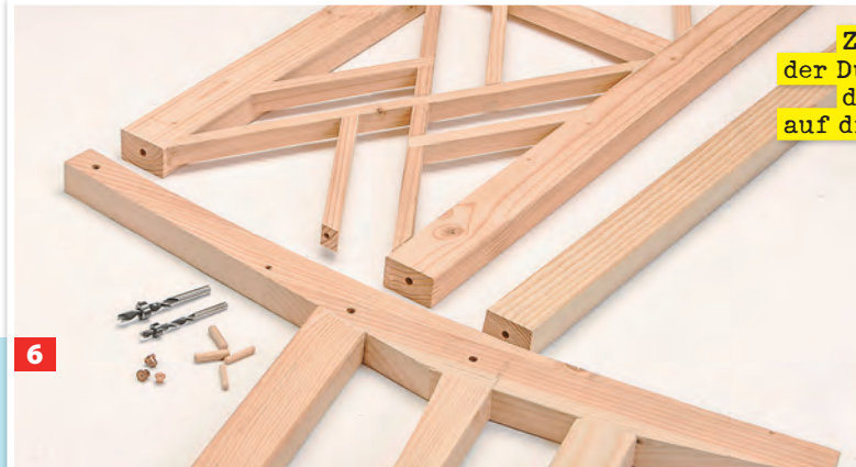
3 Die rechte Bankseite wird von den Holmen durchdrungen. Zeichnen Sie die Durchdringungen an.
