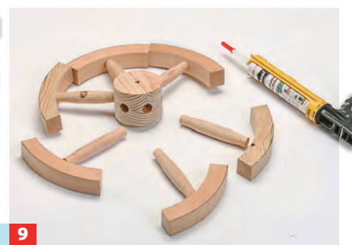
Setzen Sie das Rad zunächst trocken zusammen. Passt alles? Dann geht's auch hier ans Verkleben. Mit dem Gurt spannen!
