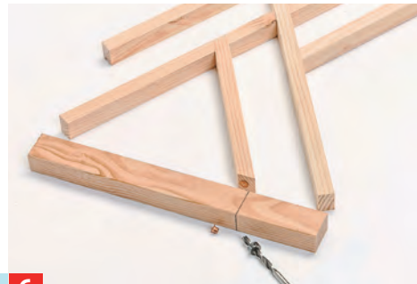
6 Dübellöcher in die Köpfe bohren und mit Markierstift auf die Mittelstrebe übertragen. Füllungen und Strebe dann verkleben.
