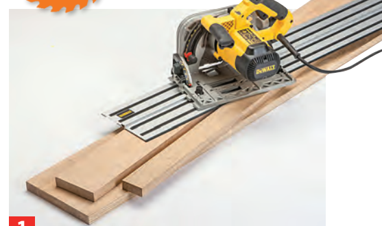
1 Querbretter und Riegel für das Kopfteil genau, Beinteile und Lamellenbrettrohling grob mit der Handkreissäge zuschneiden.
