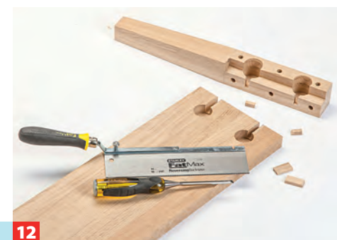
12 ... Holz rechts und links mit der Feinsäge einschneiden. Die Nuten werden dann mit einem schmalen Beitel ausgestemmt.
