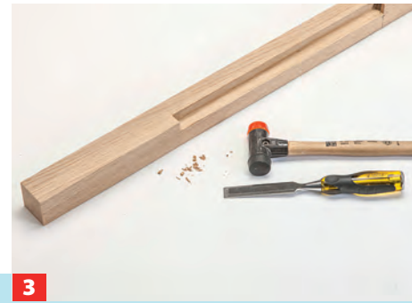
3 Die Fräserrundungen stemmen Sie dann sauber mit einem scharfem Beitel aus.
