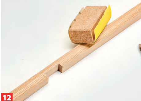
12 Tipp: Schleifen Sie die Lamellen bereits jetzt rundum, und brechen Sie die Kanten. Erst dann mit den Riegeln verleimen.
