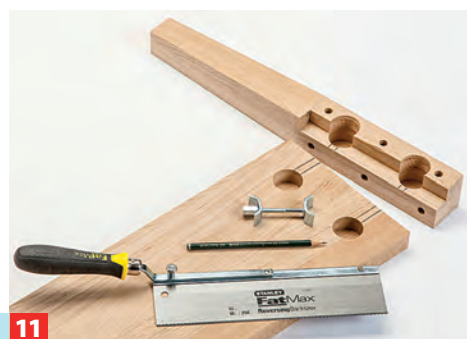
11 Auch die Seitenzargen für die Arbeitsplattenverbinders bohren. Zur Herstellung der Nuten für die Verbindungsschrauben das ...
