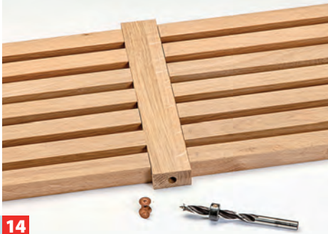
14 Austretenden Leim nach dem Anziehen abstechen. Nach dem Abbinden die Riegel an beiden Stirnseiten für 10er Dübel bohren.
