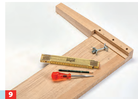
9 Die Verbindung von Füßen zu Seitenzargen muss zum Transport demontierbar ausgeführt werden. Hier kommen je zwei 65er ...
