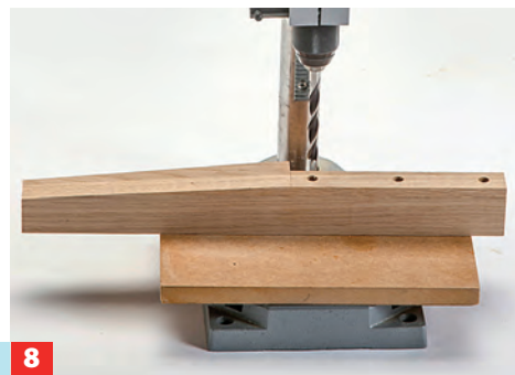
8 ... ins Kopfholz der Zargen bohren und dann (leicht zurückspringend; Sperrholz unterlegen) auf die Füße übertragen und bohren.
