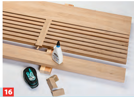
16 An den Abdrücken der Markierspitzen bohren, Leim in die Dübellöcher und an die Kopfflächen geben, Dübel einstecken und die ...
