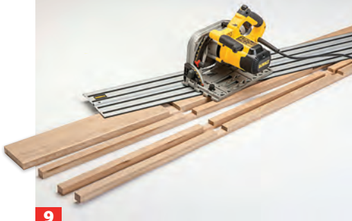
9 Erst jetzt schneiden Sie den gefrästen Rohling in Einzellamellen auf. Mit Handkreissäge und Schiene gelingt dies sehr genau.
