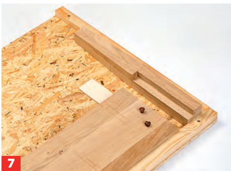
7 Dann werden die Dübellöcher für Bein und Fußzarge sowie für Bein und Seitenzargen markiert. Immer zunächst die Bohrungen ...
