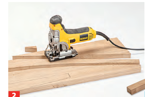
2 Beginnen Sie mit den Beinelementen. Die Kontur (angegeben auf dem Bauplan) aufzeichnen und zunächst ein Mal zuschneiden.
