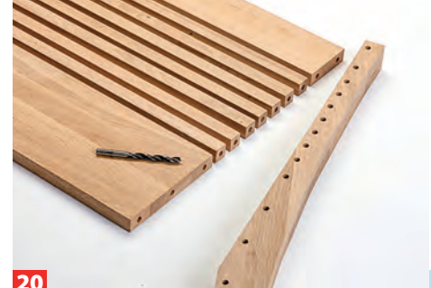
20 Nun auf beiden Seiten die Dübellöcher an den Nagelmarkierungen bohren.
