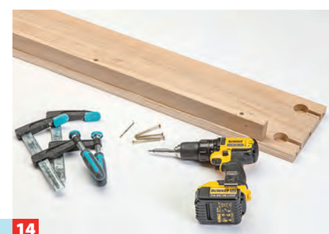
14 Leimen und schrauben Sie die Auflager für die Lattenroste auf beide Seitenzargen. Platz für die Verbindungsbeschläge lassen!
