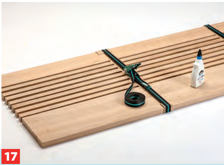
17 ... Bauteile zusammensetzen. Mit großen Zwingen oder Spanngurten verpressen (Eckenschoner unterlegen). Abbinden lassen.
