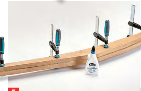
5 Schablone und Kopie werden nun jeweils mit einem weiteren Grobzuschnitt verleimt. Sorgfältig mit Zwingen verpressen!
