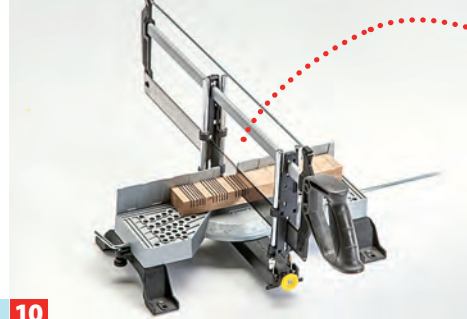
10 Anschließend müssen Sie die Überblattungen der Riegel herstellen: Mit der Präzisionsgehörungssäge (mit Tiefenbegrenzer) schneiden ...
