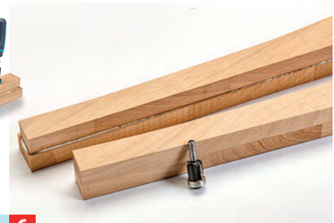
6 Nach Abbinden des Leims wird wiederum bündig gefräst. Damit erhalten Sie zwei identische, aufgedoppelte Beinteile.
