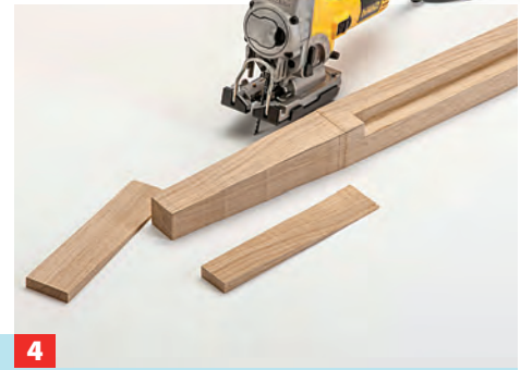
4 An beiden Enden werden anschließend die beiden inneren Fußflächen leicht schräg mit der Stichsäge zugeschnitten.
