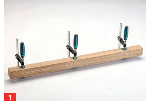
1 Die unteren Füße werden aus zwei Streifen Leimholz aufgedoppelt. Stellen Sie nur einen solchen Rohling für beide Füße her!
