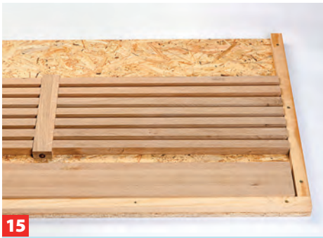
15 In einer großen Winkellade übertragen Sie die Dübellöcher mit Markierstiften auf das obere und untere Querbrett.
