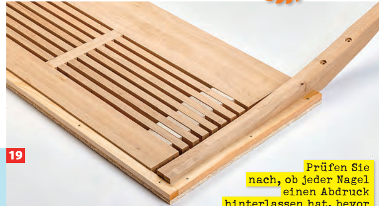
19 Prüfen Sie nach, ob jeder Nagel einen Abdruck hinterlassen hat, bevor Sie die Nägel wieder entfernen.
