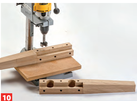
10 ... Arbeitsplattenverbinders* zum Einsatz. Mit Holzdübeln trocken zusammenstecken, Lage anzeichnen und 35er Sacklöcher bohren.
