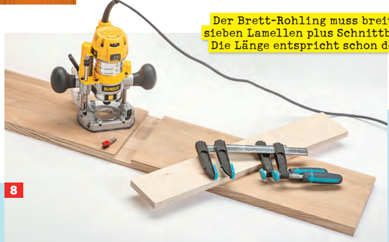
8 Weiter geht es mit dem Lamellenbrett: Fräsen Sie die beiden Nuten für die Überblattungen schrittweise exakt auf Breite und Tiefe.
