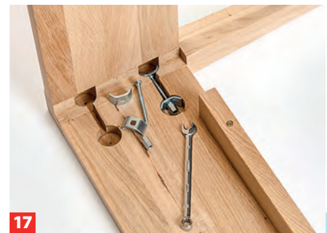
17 Zum Schluss werden die Fußteil-Verbinder eingesteckt und angezogen; der Bettrahmen ist damit komplett aufgebaut.
