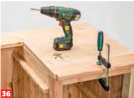
36 Klebstoff auf den Rahmen geben, die Platte auflegen und von unten verschrauben.
