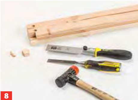
8 Beide Eckhölzer – soweit möglich – mit der Fein- oder Japansäge einschneiden und die Ausklinkungen ausstemmen.
