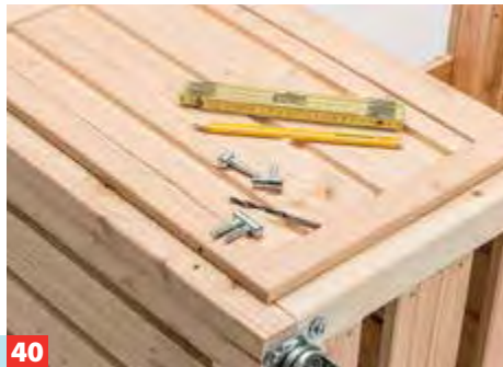
40 ... und mit 13-mm-Einbohrbändern jeweils im äußeren Rahmenholz angeschlagen. Innen werden Magnetschnäpper verschraubt.
