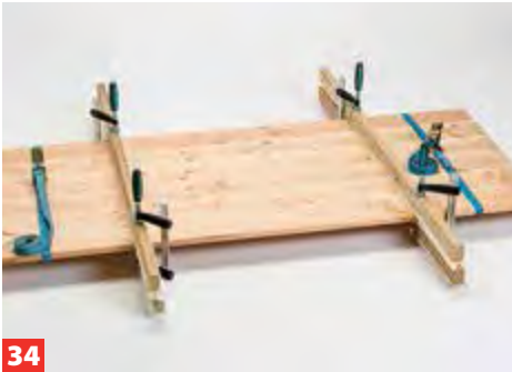
34 Suchen Sie die besten und geradesten Glattkantbretter aus und verkleben Sie daraus mit etwas Übermaß die Arbeitsplatte.
