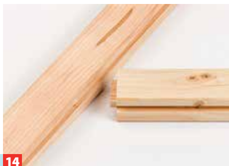
14 ... zu sehen, rechts nur eine Zulage, um den Ausriss beim Fräsen zu verhindern! Die Zapfen greifen in die Nuten der Längsholme.
