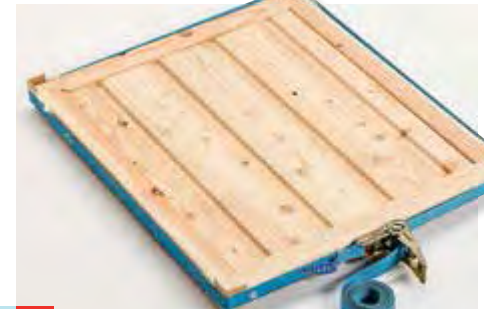
23 Prüfen Sie wieder auf Rechtwinkligkeit und achten Sie darauf, dass die Elemente durchs Verspannen nicht windschief werden.
