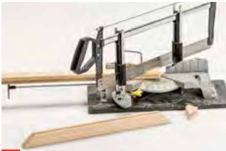
21 Die Rahmenhölzer schneiden Sie auf Geh-rung – wie hier von Hand oder maschinell mit der Kapp- und Gehrungssäge.
