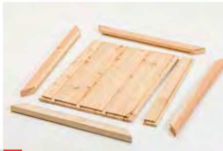
22 Füllungen zuschneiden und falzen, anschließend die Zwischenwände verkleben.
