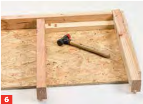
6 Weiter geht es mit den Zwischen-Stehholmen der jetzt liegenden Front: Dübellöcher bohren, mit einem Distanzholz den ...
