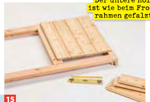
15 Eckholme verdübeln, unten ausklinken, Zwischenholme positionieren und Nut- und Federbrett-Füllungen vermittelt auflegen.
