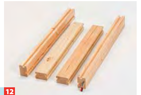
12 Stellen Sie die Rahmenhölzer der Rückwand her – hier die Stehholme; die Längsholme erhalten eine durchgehende Nut.
