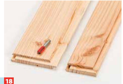
18 ... Köpfe mit der Präzisions-Gehrungssäge entsprechend tief einschneiden. So sehen zwei Füllungsbretter anschließend aus.
