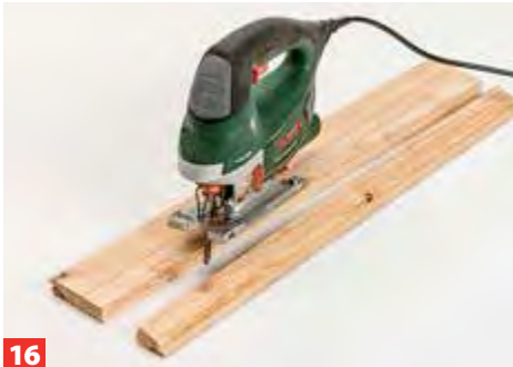
16 Trennen Sie die jeweils äußeren Füllungsbretter eines jeden Feldes entsprechend längs auf. Die Bretter werden oben und ...
