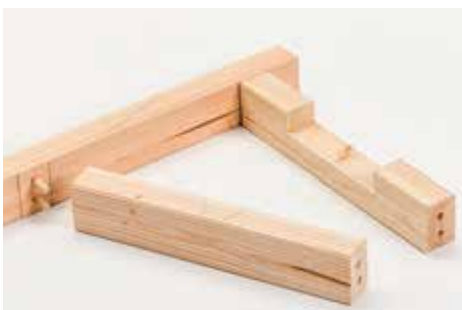
24 Stellen Sie nun die Kochplattenaufnahme für den linken Seitenschrank her. Den vorderen Holm müssen Sie ausklinken.
