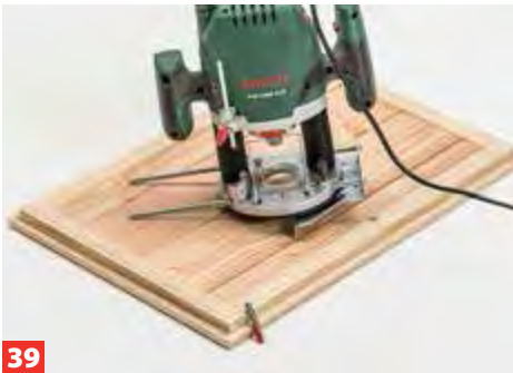
39 Anschließend werden die Türen auf der Rückseite umlaufend gefalzt ...
