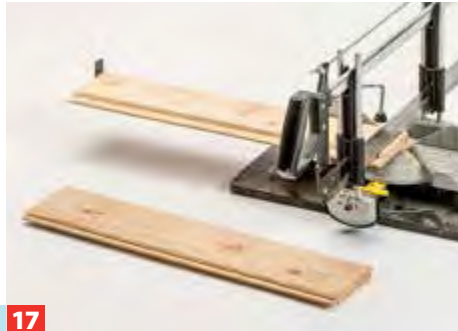
17 ... unten sowie an den Außenseiten gefalzt, um in die Nut zu passen. Tipp: Um Ausriss beim Fräsen zu verhindern, ggf. vorher die ...
