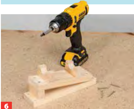
6 Der Anstellwinkel des Mühlrads wird durch eine Basisplatte mit Distanzstück eingestellt. Alles verleimen und verschrauben.
