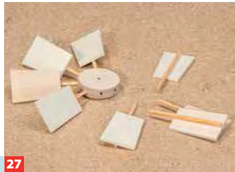
24 Die Ruten werden an der Nabenseite lotrecht eingebohr. Dort die Klobenschraube (mit abgesägtem Kopf) mittels ...
