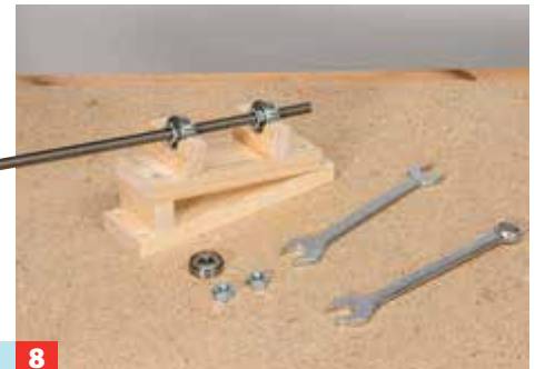
8 Die Lager sollten mittig in den Lagerschalen sitzen. Tipp: zur Sicherung der Muttern einen Tropfen Sekundenkleber angeben.
