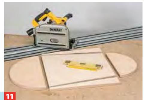
11 Anschließend die trapezförmige Hauben-Grundplatte zusägen. Der Zuschnitt der vorderen Kante (zur Stirnplatte) erfolgt als ...
