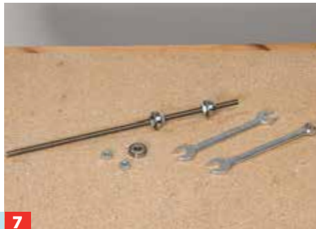
7 Die Welle in Form einer M10-Gewindestange aus Edelstahl ablängen und darauf die Lager mit Muttern fixieren.
