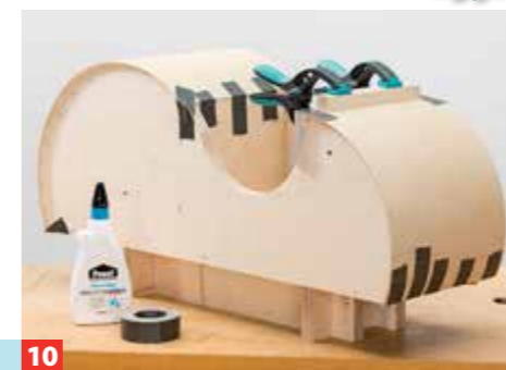
10 ... nach Leimangabe auf den Randabschlüssen der Beiwagenkonstruktion auflegen und mit Klemmen bzw. Gewebeband anpressen.
