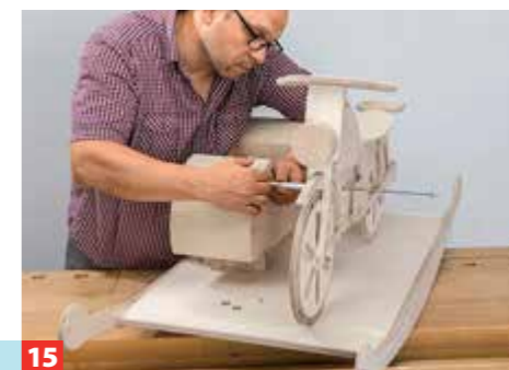
15 Zwei Gewindestangen und Hülsen führen Sie vom Rahmen durch den Beiwagen bzw. von der Hinterrad- durch die Beiwagen-Radnabe.
