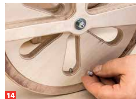
14 ... den Abstand zum Motorrad. Dieses wird mit Gewindestangenabschnitten und Hutmuttern auf die Bodenplatte montiert.
