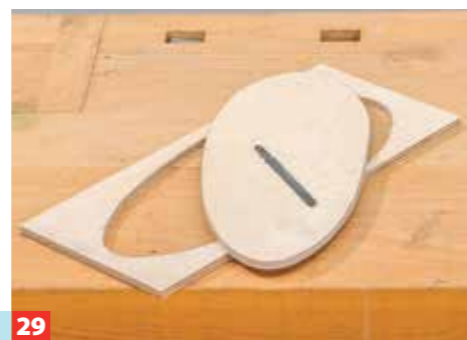
29 Aus 6,5-mm-Multiplex schneiden Sie nun den Sattel heraus und schleifen und brechen die Kanten mit Schleifpapier.
