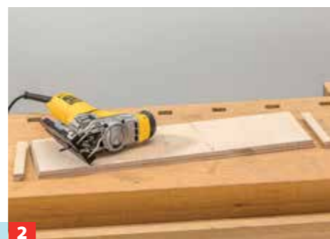
2 ... Boden gegen die Seite stellen, dann vorn und hinten den Winkel der Bodenplatte anzeichnen. Mit der Stichsäge zuschneiden.
