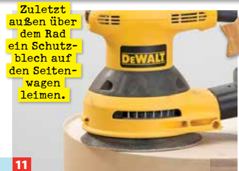
11 Zuletzt außen über dem Rad ein Schutzblech auf den Seitenwagen leimen. Nach dem Abbinden des Leims die Überstände behutsam mit dem Hobel oder dem Exzentrerschleifer abtragen.
