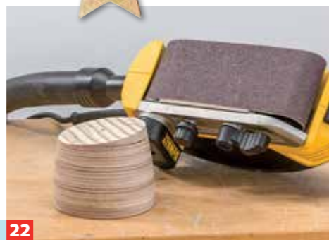
22 ... Bandschleifer mit grobem Schleifband. Zuletzt die Rückseite im Winkel der Gabelausrichtung schräg schleifen.
