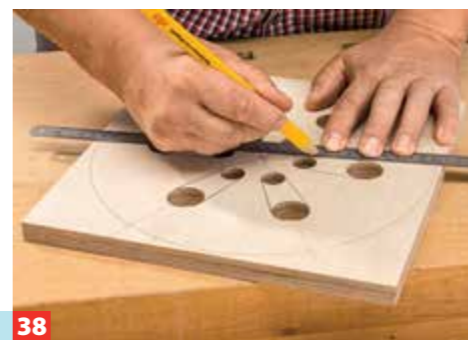
38 Kreis aufzeichnen und in sechs Segmente teilen. Auf den Segmentgrenzen je ein 20er und ein 30er Loch bohren und die ...
