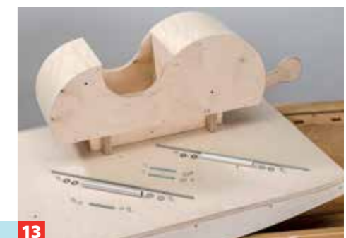
13 Den Beiwagen verschrauben Sie von unten durch die Grundplatte in den Sockelrahmen. Gewindestangen und Alurohre definieren ...
