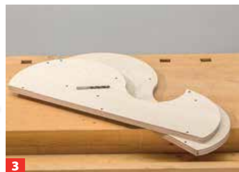
3 Bohren Sie – soweit jetzt schon möglich – die Dübellöcher in den Seitenwagen
