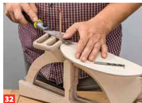
32 Den Gepäckträger aufdübeln: Hierzu durch das Material in den Rahmen bohren, Dübelstangen einleimen und bündig absägen.
