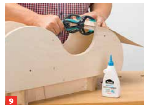
9 Verleimen Sie jetzt den Beiwagen und das Untergestell. Mit Zwingen verpressen. Anschließend die 2-mm-Sperrholzplatten ...
