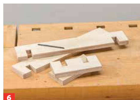
6 Für eine sichere Verbindung zwischen Beiwagen und Basis wird ein Sockel hergestellt. Die Sockelbretter überblatten.
