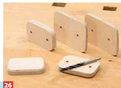
26 Zwei Dübellöcher – in den Kopfplatten als Sackloch ausgeführt – verbinden die Scheiben untereinander und mit dem Rahmen.
