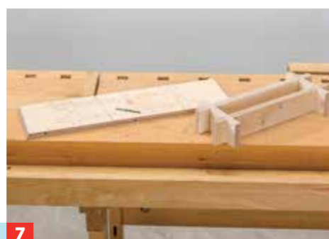
7 Mit Holzdübeln wird auch die Leimverbindung zwischen Sockel und Beiwagen-Bodenplatte verstärkt.
