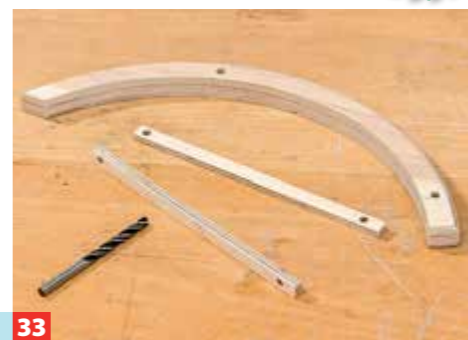
33 Schneiden Sie das Vorderrad-Schutzblech zu und runden es ab, dann die Streben zuschneiden. Beides bohren.
