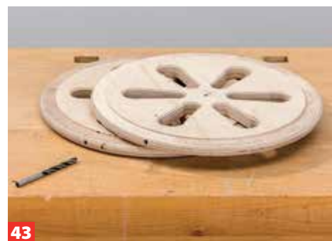
43 Da das Motorrad durch die Felgen mit der Grundplatte verschraubt wird, bohren Sie bei zwei Rädern je ein 6-mm-Loch bis in den ...
