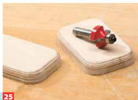
25 ... dicker und größerer dünner Multiplexscheiben. Die Kopfplatten werden außen mit dem Abrundfräser gerundet.
