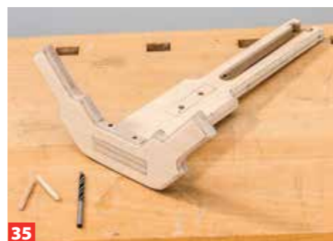
35 Auch Lenker und Gabel jetzt verdübeln: Die Bauteile durchbohren, Leim angeben, Dübel einsetzen und bündig ablängen.
