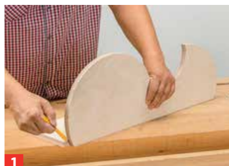
1 Auch Seiten, Boden, Sockel, Rückwand und Verbindungsstrebe des Beiwagens schneiden Sie aus Multiplex zu. Den überlangen ...
