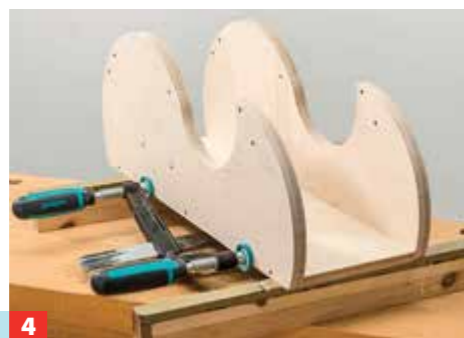
4 Boden zwischen den Seiten verspannen und die Dübellöcher durch die Seiten in die Kanten verlängern.
