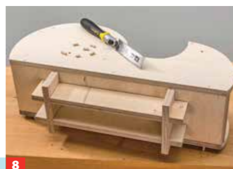
8 Hierzu die Dübellöcher wieder übertragen und kurze Dübelabschnitte zuschneiden.
