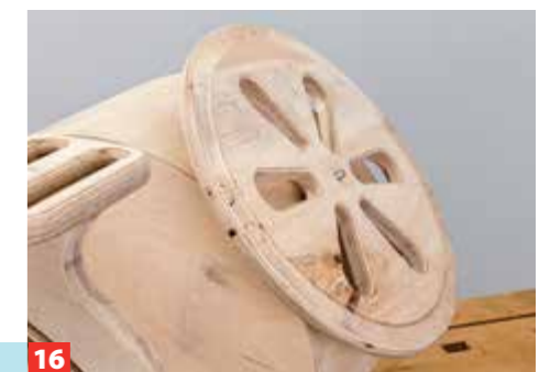
16 An einer Stockschraube, die durch das gebogene Sperrholz in den hinteren Querriegel geschraubt wird, befestigen Sie das Reserverad.
