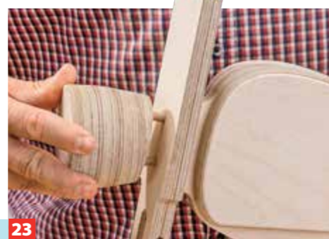
23 Mit Dübelmarkierern die Dübelposition der Gabel auf den Scheinwerfer übertragen und dort die Bohrungen einbringen.
