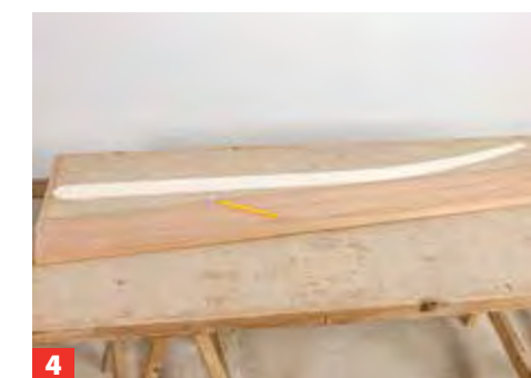
4 Die Schablone nun auf das 27 mm starke und 190 mm breite Meranti-Glatkantbrett legen und die Umrisse aufzeichnen.
