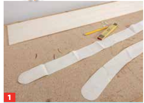
1 Beginnen Sie mit den Rahmen von Kopf- und Fußteil. Schneiden Sie die Schablonen aus dem Bauplan aus oder kopieren Sie ...
