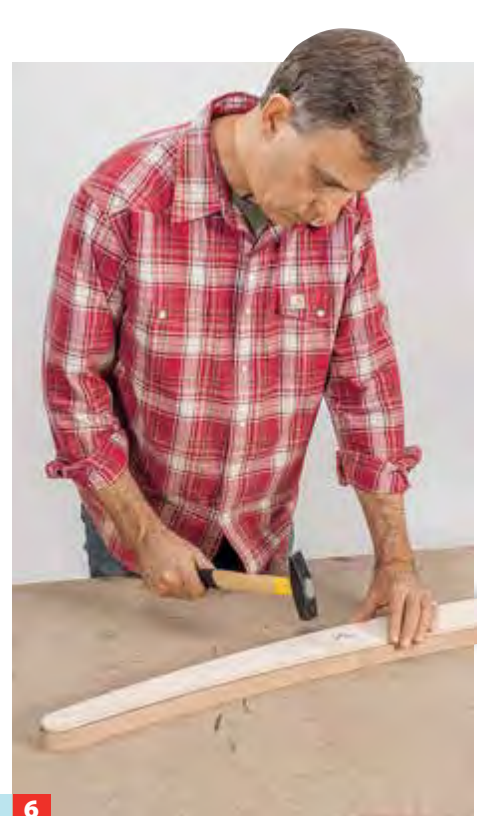
6 Heften Sie die Schablone mit dünnen Drahtstiften innen auf den Holm-Rohling.
