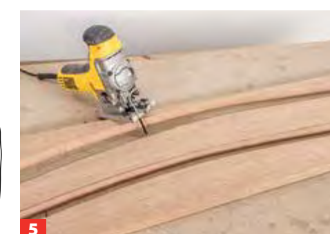
5 Sägen Sie das Material etwas außerhalb der Kontur mit der Stichsäge zu. Sie benötigen jeweils zwei Sitz- und Lehnenholme!
