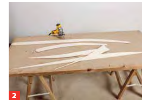
2 ... sie und übertragen sie dann auf dünne Hartfaser- oder Sperrholzplatte. Dann sägen Sie die Bauteile genau aus.
