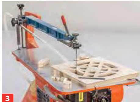
3 Nun können Sie die Wasserrad-Scheiben ausschneiden – mit der Laubsäge oder, wie hier, komfortabler mit der Dekupiersäge.
