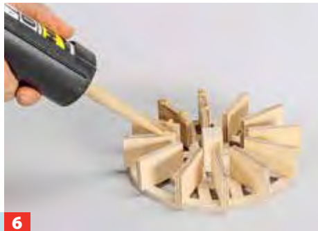
6 Nachdem der Klebstoff leicht angezogen hat, können Sie an Nabe und Schaufelkanten erneut Klebstoff geben.
