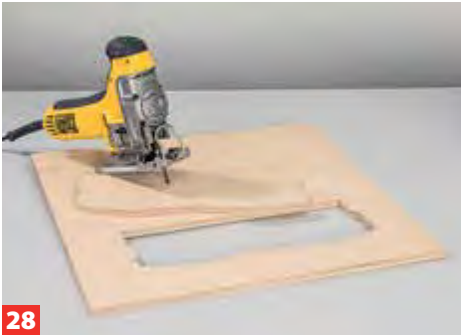
28 Dann sägen Sie mit der Stichsäge den Ausschnitt heraus. Die Bauteile für den Sockelkasten zuschneiden und verschrauben.
