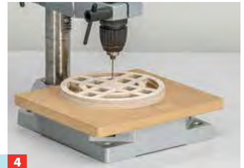
4 Die noch aufeinanderliegenden Scheiben möglichst exakt mittig mit einem 2-mm-Bohrer durchbohren.
