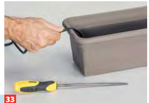
33 Um die Anschlussleitung der Pumpe aus dem Blumenkasten herauszuführen, feilen Sie eine Rundkerbe in den Rand.
