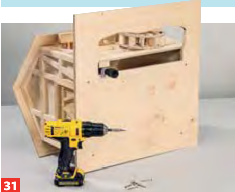
28 Dann sägen Sie mit der Stichsäge den Ausschnitt heraus. Die Bauteile für den Sockelkasten zuschneiden und verschrauben.
