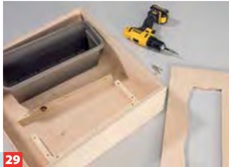
29 Damit das Wasserbecken – ein 40-cm-Blumenkasten – nicht verrutscht, bringen Sie auf der Grundplatte Leisten an.
