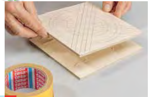
2 ... und fixieren diese mit doppelseitigem Klebeband in den Ecken auf einer ebenso großen zweiten Platte.
