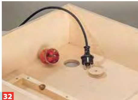
32 Zum Herausführen des Steckers haben wir ein Loch in die Grundplatte geschnitten und in den Ecken Möbelgleiter untergeschraubt.
