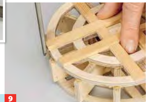
9 Nachdem der Kleber ausgehärtet ist, werden die Überstände der Leisten mit der Feile nachbearbeitet.
