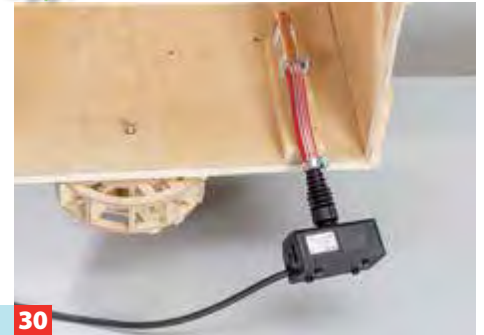
30 Im Mühlenhaus schließen Sie nun die Pumpe mit einem Stück \frac{3}{8} -Zoll-Gartenschlauch und Schlauchschellen an das Kupferrohr an.
