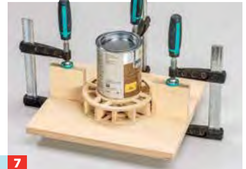
7 Bei der Zentrierung der Scheiben hilft eine solche Lade. Als Beschwerung dient z. B. eine volle Lackdose.
