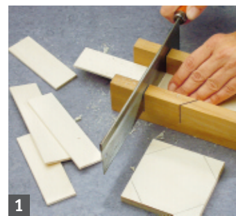
1 Schneiden Sie zunächst die acht Klangzungen auf Länge. Das geht in der Gehrungslade am besten
