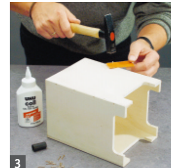
3 Geben Sie Holzleim an und verbinden Sie die vier Seitenwände stumpf mit kleinen Nägeln
