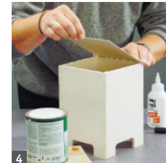
4 Geschlossen wird die Trommel mit dem quadratischen Deckel aus dünnem Sperrholz
