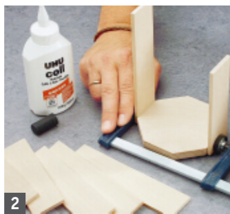
2 Nun werden die Zungen jeweils paarweise mit Holzleim fixiert und bis zum Abbinden eingespannt
