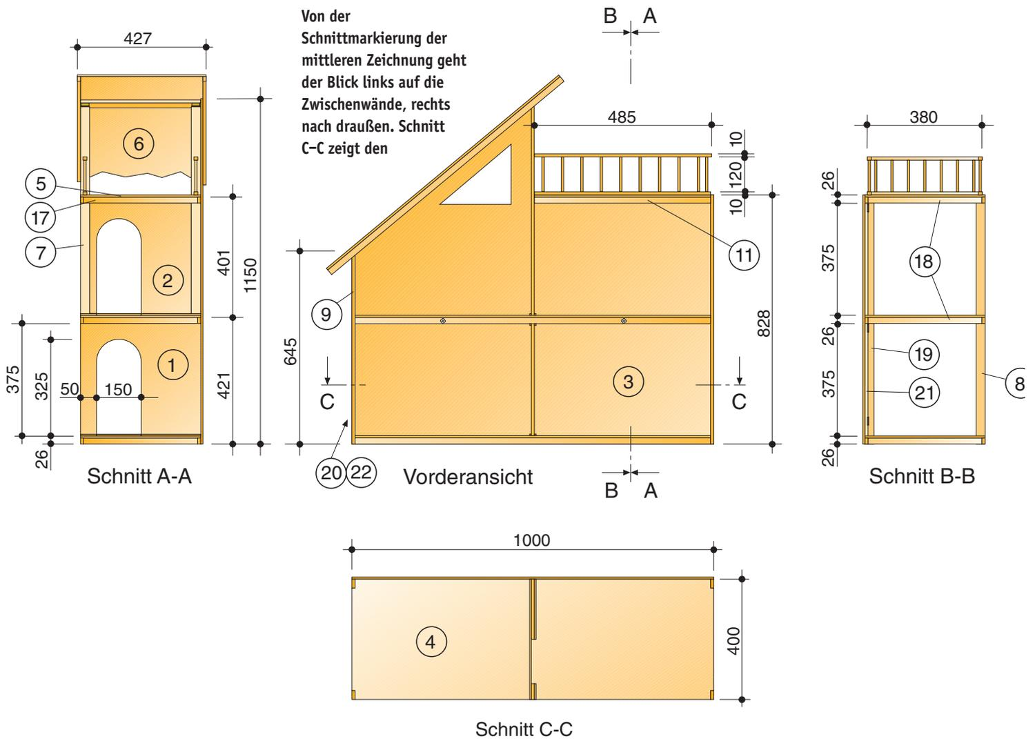
In der hinteren Bodenleiste (10) des Zwischenbodens sehen Sie die Zugmuttern. Beim Zusammenstecken greifen die Bodenleisten (12) über die Querleisten (18) der Wandrahmen (s. „Aufbau“, Detailfoto 2)
