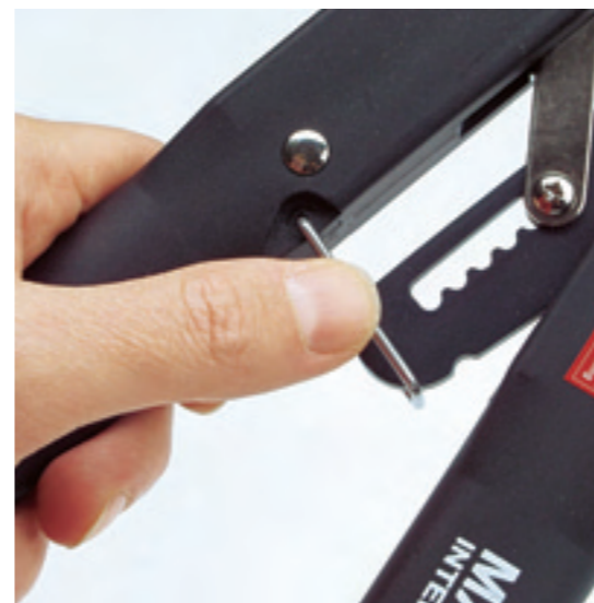
Mit einer Ratschenmechanik zeigt die Schere von Master einen neuen Weg des Antriebs – im Test konnte sie jedoch nicht überzeugen
