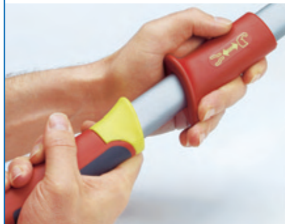
Die Umschaltung der Vario-Mechanik bei Wolf (siehe links oben) erwies sich als schwergängig
