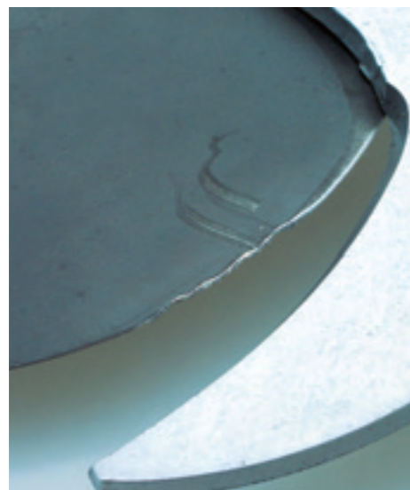
Das Modell 315375 von Lux zeigte nach unseren Testschnitten als einzige Schere im Test deutliche Verschleiss-Spuren an der Klinge
