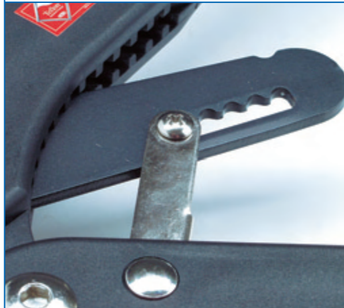
Das Konzept, dicke Äste mit mehreren Bedienhüben zu teilen, ist bei Astscheren neu – die Mechanik von Masters war in der praktischen Bedienung allerdings zu hakelig und rastete nicht zuverlässig ein
