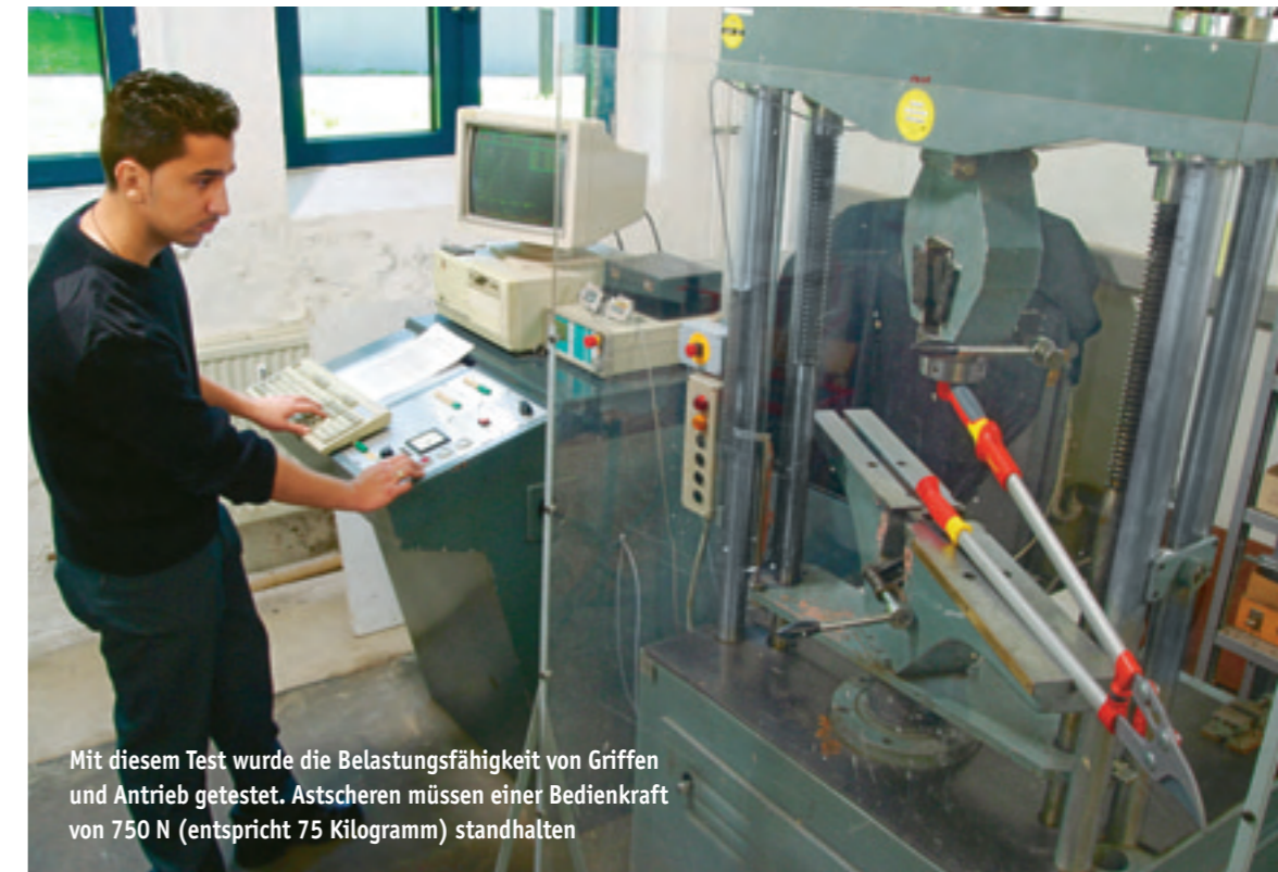
Mit einer Ratschenmechanik zeigt die Schere von Master einen neuen Weg des Antriebs – im Test konnte sie jedoch nicht überzeugen
