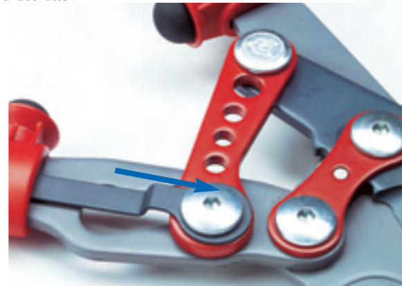
Die nach der Umschaltung verfügbare Kraftreserve muss man allerdings mit einer größeren Öffnungsweite der Griffe erkaufen – wie bei allen Übersetzungen
