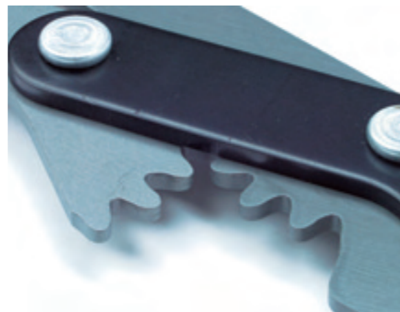
Getriebe- und Hebelübersetzungen haben sich bei Astscheren allgemein durchgesetzt. Allerdings muss die größere Schnittkraft mit einem größeren Bedienweg erkaufte werden
