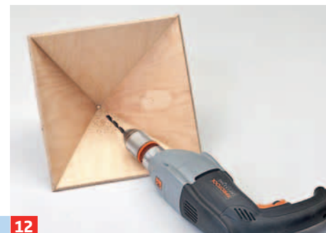
12 Nach dem Trocknen von innen in die Pyramidenspitze ein Loch für die obere Messing-Lagerhülse bohren.
