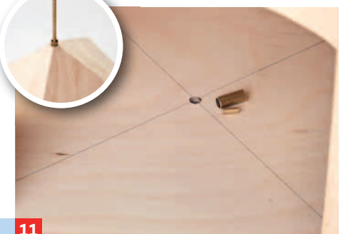
11 ... Verkleben der Lagerplättchen einsetzen. Messingrohr-Abschnitte dienen als Lagerhülsen in Boden und Dach.
