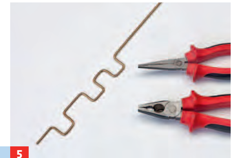
5 Weiter geht es mit der Kurbelwelle. Biegen Sie die drei Hub-Positionen zunächst flach, dann den oberen Hub ...
