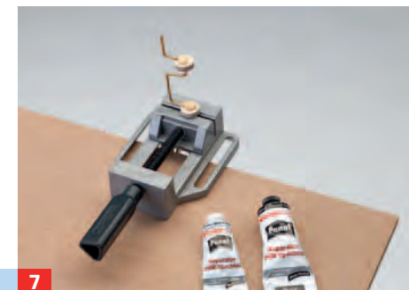
7 Fädeln Sie nun die Lagerplättchen auf die Welle und kleben diese von unten an den Hubbereichen der Kurbel fest.
