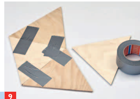
9 ... Dachflächen. Vorritzen verhindert Ausriss! Von der Außenseite die Dreiecke mit Gewebeklebeband verbinden.
