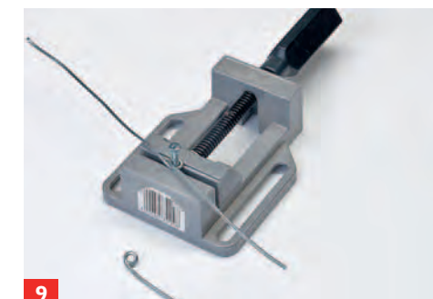
9 ... der an einer Seite eine gebogene Öse erhält. Diese lässt sich einfach über eine eingespannte Schraube biegen.
