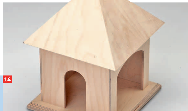
Klebstoff auf den oberen Wandabschluss und den Dachabschluss auftragen und die Teile zusammenfügen.
