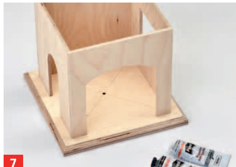
7 Die Außenwände kleben Sie nun mittig auf die Grundplatte.
