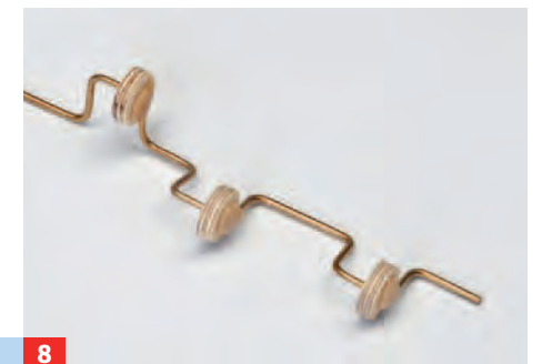
8 So sieht anschließend die Kurbelwelle aus. Die Kraftübertragung auf Tür und Fenster erfolgt durch stabilen Draht, ...
