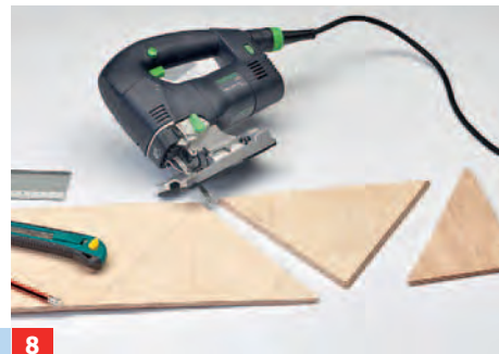
8 Weiter geht es mit dem Dach: Aus einem Multiplex-Streifen schneiden Sie mit der schräggestellten Stichsäge die vier ...
