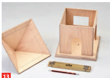
13 Dach trocken auf die Wände setzen, waagrecht ausrichten und die Wandanschlusssebene von innen einzeichnen.
