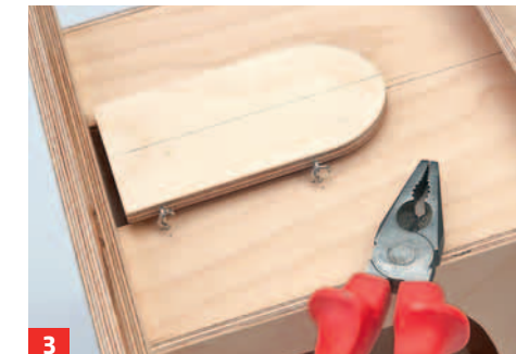
3 Die Tür am besten einhängen, wenn die Ösenschrauben leicht schräg stehen. Dann die Ösen zukneifen und ausrichten.
