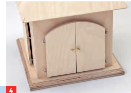
4 Auch die Fensterläden und das Tor in dieser Weise anschlagen. Das Tor erhält zusätzlich einen Schatullenverschluss.
