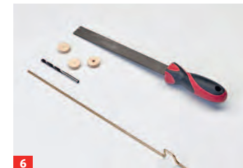
6 ... verdrehen. Lagerplättchen aussägen, durchbohren und entgraten. Die Kurbelenden müssen fluchten!
