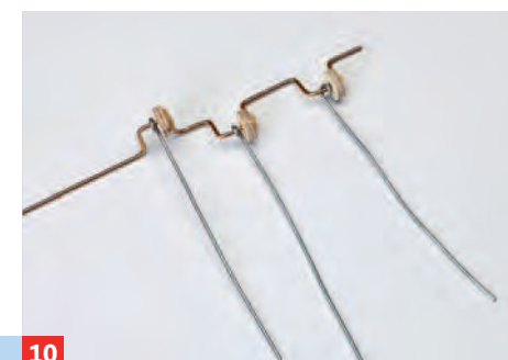
10 Die Ösen der beiden unteren Drähte leicht aufbiegen und auf der Kurbel schließen. Alternativ bereits beim ...
