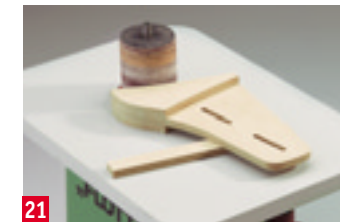
21 Aufdoppelungen verleimen. Zulage für sicheren Halt unterlegen und die Wölbung des Sattels einschleifen
