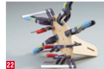
22 Sattelplatten (Ränder mit Klammern pressen!) miteinander und zugleich mit dem Sitzträger verleimen
