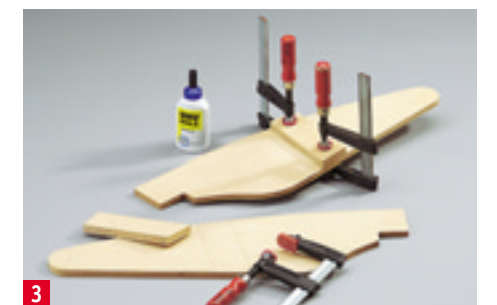
3 ... nach hinten öffnenden Rahmen an. Danach erst teilen und an den Rahmeninnenseiten verleimen
