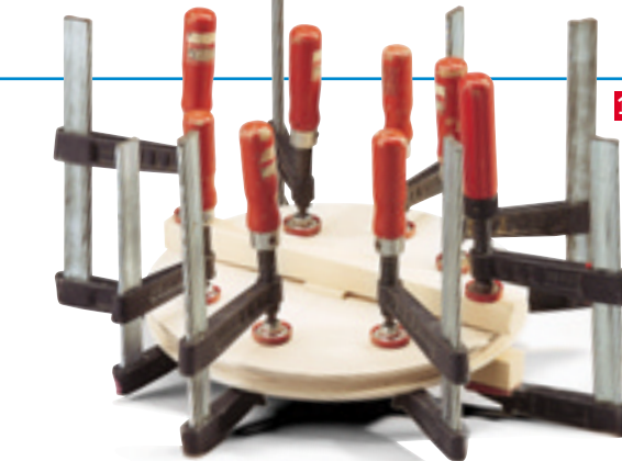
9 Gabelteile verleimen. Mit der Lochsäge Rundung ausschneiden. Achsloch von beiden Seiten bohren
