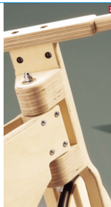
28 ... Aufdoppelungen verleimen, anschrägen und die Stützplatte verleimen und verschrauben
