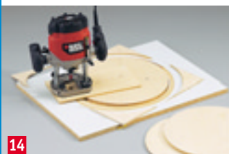
14 Radscheiben mit einer Fräshilfe fertigen: die äußeren mit 177 mm, die inneren mit 167 mm Radius
