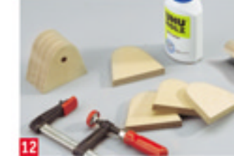
12 Scheiben der Achslager großzügig ausschneiden, verleimen und Kanten am Tellerschleifer auf Maß bringen
