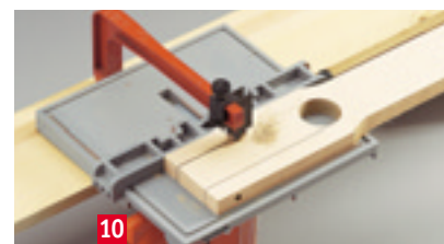
10 Danach das Loch nach unten verlängern, und zwar zuerst mit dem vom Anschlag weg liegenden Schnitt
