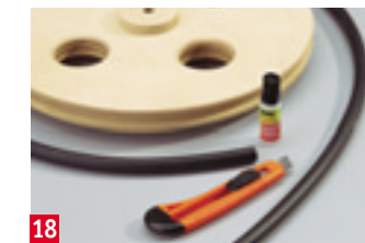
18 Perbunan-Litze übereinander legen, mit geradem Schnitt ablängen. Sekundenkleber einseitig auftragen
