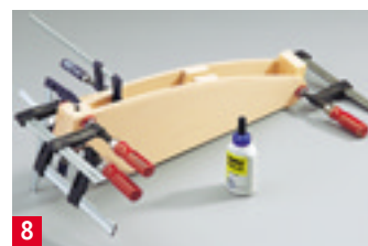
8 Spannen Sie beim Verleimen des Rahmens ein Brett gegen den Achsklotz, damit dieser nicht verrutscht
