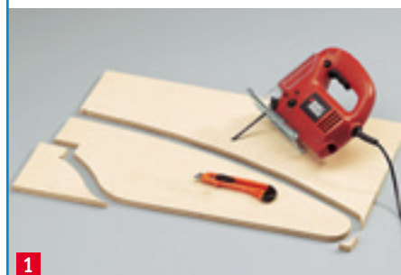
1 Zwei Rahmenbretter aus einer Platte von 630 x 360 mm schneiden. Die Kontur vorher anritzen
