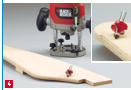
4 Brechen Sie die Außenkanten mit dem Abrundfräser; hinten nicht wegen der Aufdoppelungen!
