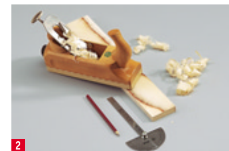
2 Aufdoppelungen halten den Sitz. Schrägen Sie diese – noch am Stück – passend zu dem sich ...
