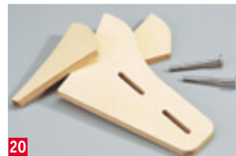
20 Beim Bohren den Sitzträger einstecken. Dessen Löcher mit Stichsäge und Bohrer nach Bauplan aufweiten
