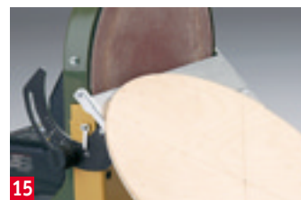
15 Äußere Scheiben innen mit 45°-Fase zur Halterung der Reifen versehen. Außenkanten von Hand abrunden
