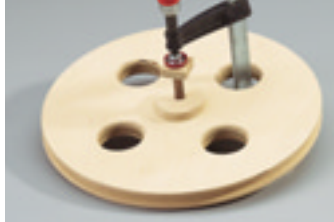
Löcher so platzieren, dass eine Ihrer Zwingen Ihnen beim Einschleiben der Achsführung helfen kann
