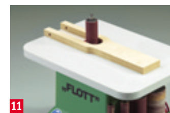
11 Die Innenrundung lässt sich mit 120er-Papier an einer Walzenschleifmaschine optimal schleifen
