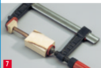
7 Drücken Sie das Kupferrohr für die Achsführung mit einer Zwinne in die Bohrung des Achsklotzes
