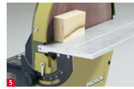
5 Auch den Achsklotz aus drei miteinander verleimten Distanzbrettern beidseitig um 1,5° ...
