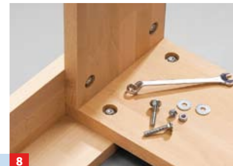
8 ... Seite der Zargen her vor. Schlossschrauben von außen durchstecken, Unterlegscheiben auflegen und verschrauben
