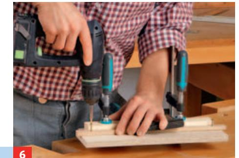
Und auch dort schrauben Sie die Laufleisten auf. **Tipp:** Schrauben leicht versetzt positionieren, damit sie nicht kollidieren.
