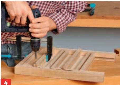
Sie lassen sich nun leicht auf die losen Seitenteile schrauben. Achten Sie darauf, sie sehr genau auszurichten!
