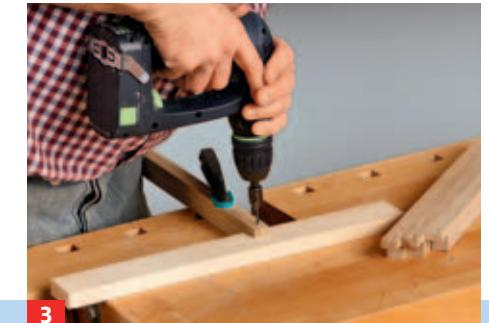
... werden können, werden diese an beiden Enden sauber ausgeklinkt und dort durchbohrt und gesenkt.
