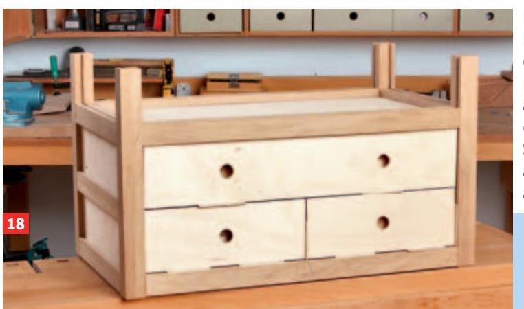
Richten Sie die Blenden mit einem gleichmäßigen Fugenabstand auf den eingeschobenen Schubkästen aus. Kurz fest andrücken, ...
