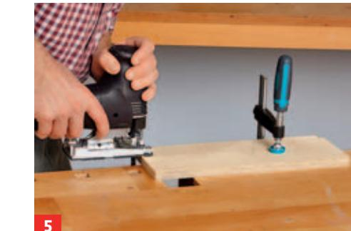
Bevor die Kiste verleimt werden kann, müssen Sie die Zwischenwand der unteren Schubkästen zuschneiden.
