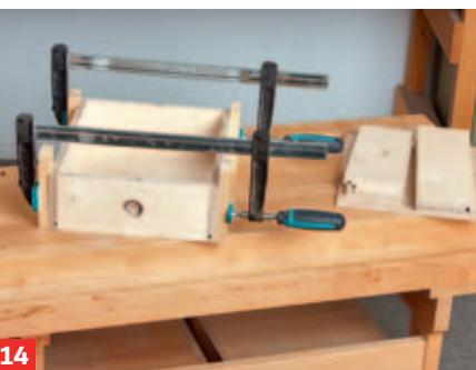
14 Anschließend verleimen Sie die Schubkästen stumpf einschließlich der Böden.
