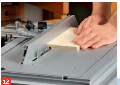
12 Die Nut für den komplett eingeleimten Boden wird wieder stationär gesägt – oder alternativ gefräst.
