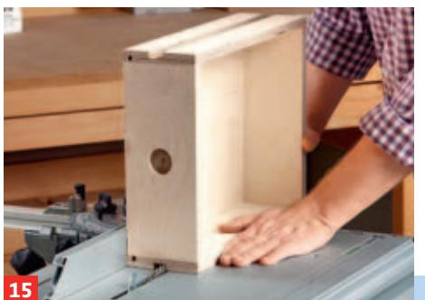
15 Schneiden (oder fräsen) Sie nun die Seitennuten für die Laufleisten.
