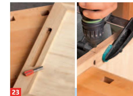
23 In den Deckel fräsen Sie (schrittweise) die Aufnahme-Nut des Aufstellholzes. Aufsteller einspannen und von der ...
