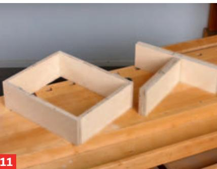
11 Die Schubkästen werden aus Multiplex gebaut. Schneiden Sie die Zargen zu.
