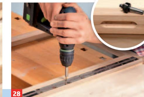
28 Griffmulde in Rahmen und Deckel fräsen und anschließend beide Bauteile mit Klavierband verbinden.
