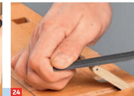
24 ... Seite durchbohren. Diese Bohrung leicht aufweiten und die Drehseite des Aufstellers mit der Feile runden.
