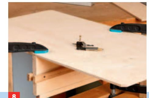
Verschrauben und verleimen Sie nun den Mittelboden T-förmig mit der Zwischenwand; das erleichtert den Zusammenbau!
