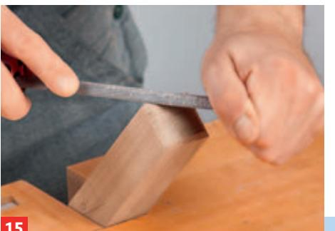
Die Eckpfosten stehen nach unten etwas über. Fasen Sie sie dort mit der Raspel oder einer Feile gleichmäßig rundum an.
