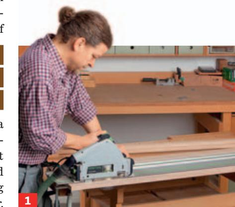
1 Die Rahmen bestehen aus 19-mm-Eicheleimholz. Schneiden Sie aus der Platte 38 mm breite Latten.
