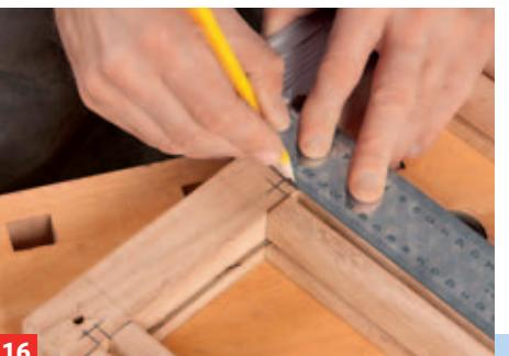
Die Böden ragen in die Eckhölzer hinein. Verlängern Sie die Nuten der Querriegel bei nur lose zusammengesteckten ...
