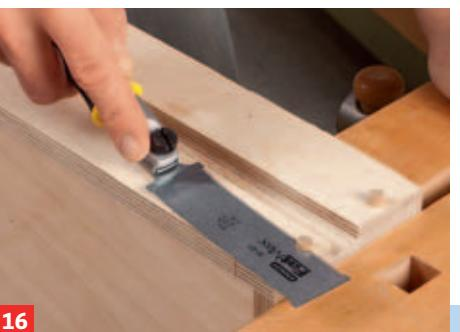
16 Zur Stabilisierung bohren Sie in die stumpfe Leimverbindung, leimen Dübel ein und schneiden sie bündig ab.
