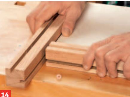
... Bohrstander bohren. Dübel-Markierstift einsetzen und die Rahmenteile an einer rechtwinkligen Platte zusammenführen.
