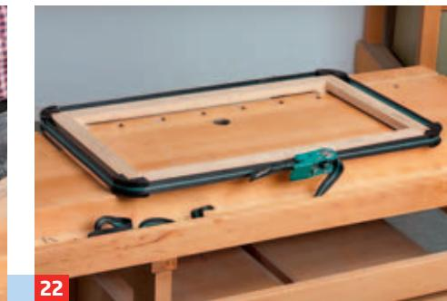
22 Den Abschlussrahmen sowie den Deckelrahmen mit Füllung verleimen und mit einem Spanngurt verpressen.
