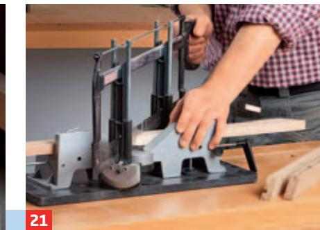
21 Der 45°-Gehrungsschnitt erfolgt wieder mit der Präzisions-Gehrungssäge.
