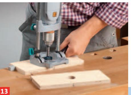
13 In die Vorderzarge bohren Sie ein Sackloch mit dem Forstnerbohrer.
