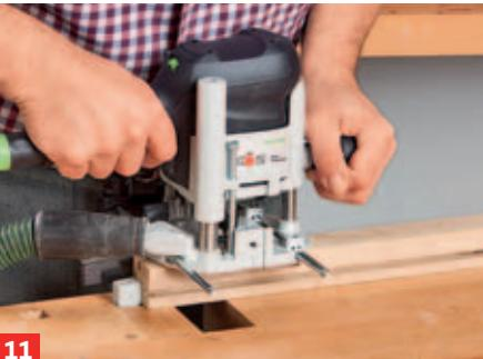
... beiden vorderen Eck-Rahmen sollte die Nut für die obere feste Füllung gefräst werden, da die Nut nicht durchgeht.
