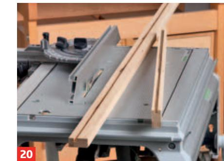
20 Es fehlt noch der obere Rahmenabschluss sowie der Deckel. Nuten Sie die Bauteile wie im Bauplan angegeben.
