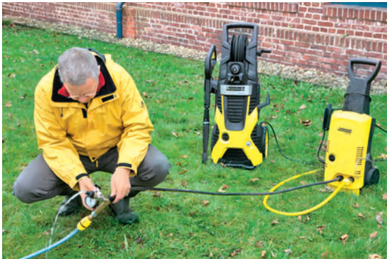
BERSTTEST: Mit einer speziellen Armatur und einem Druckmesser wurden die Schläuche allmählich mit Wasserdruck belastet
