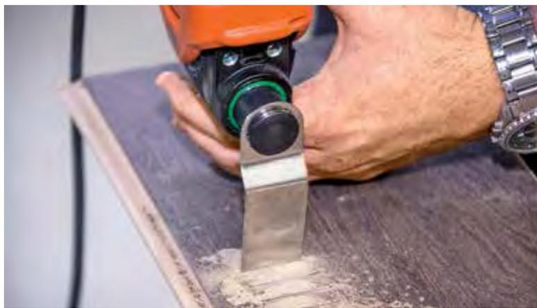
**TAUCH-SCHNITT:** Diese Anwendung ist eine Spezialität der Maschinen – wir haben die (Holz-)Sägeblätter an Laminat getestet und die Sägezeit verglichen.
