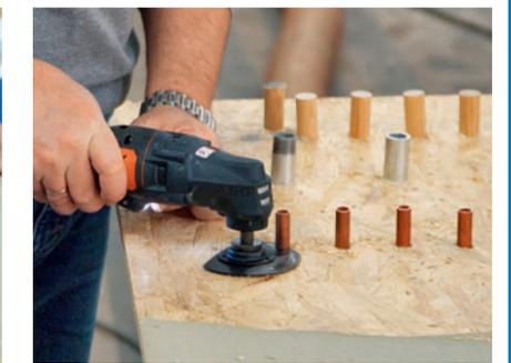
An eingeklebten Holz- und Rohrab-schnitten testete der TÜV die Sägen
