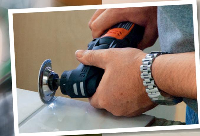
FLIESENUGEN waren mit allen Testkandidaten gut zu entfernen, benötigt wird ein diamant-besetztes Fräswerkzeug
