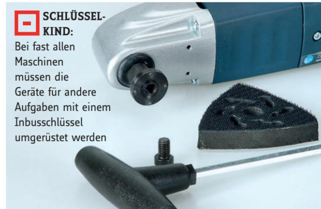
**SCHLÜSSELKIND:** Bei fast allen Maschinen müssen die Geräte für andere Aufgaben mit einem Inbusschlüssel umgerüstet werden
