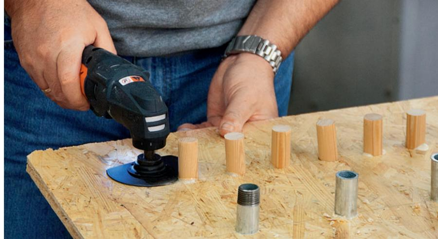
**SÄGEN:** Vorteil der Multitools ist die Möglichkeit, Rohre und Konstruktionshölzer flächenbündig absägen zu können. Fast alle Geräte waren hier gut zu gebrauchen
