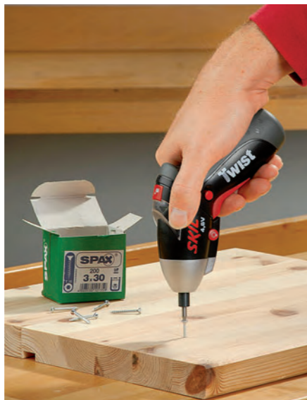
Unbequem ist ein zu großer Winkel: Die Führung der Werkzeugspitze ist ungenauer, außerdem muss das Handgelenk je nach Schraubposition stark angewinkelt werden
