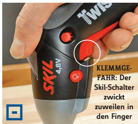
DREHBAR ist bei Skil der Gerätekörper – so wird das Gerät zum Stabschrauber
