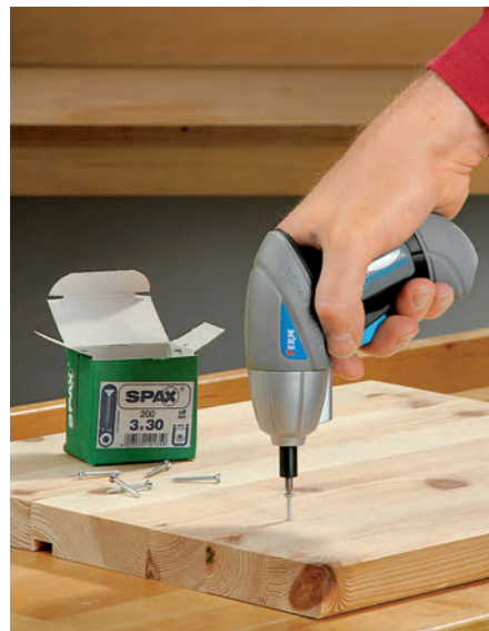
Gute Kontrolle ermöglicht ein fast senkrecht zur Motorachse abgewinkelter Griff. So wird auch eine recht große Andruckkraft gut auf die Schraubstelle übertragen
