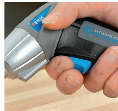
UNPRAKTISCH: Der Wippschalter bei Ferm ist schwer bedienbar
