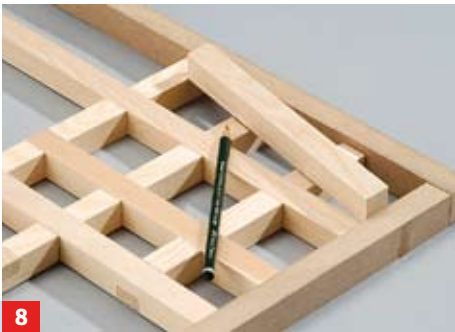
2 Mit der Gehrungssäge (Tiefenanschlag einstellen!) bis zur halben Holzstärke einschneiden. Lassen Sie den halben ...
