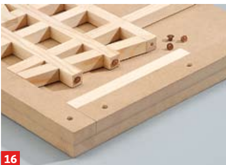
12 Fertigen Sie zunächst die Überblattung und sägen dann den Türriegel aus. Am einfachsten gelingt dies mit einer ...
