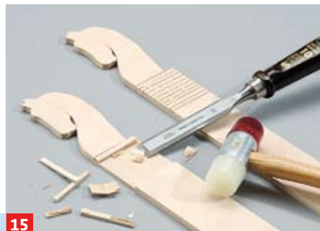
15 Die Ortgangblenden aus Sperrholz mit der Laub- oder Dekupiersäge ausschneiden und die Überblattungen anfertigen
