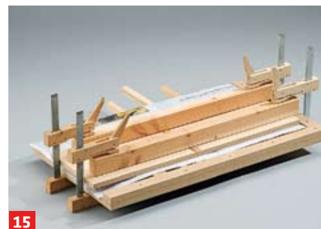
15 Zeitungspapier unter- und auflegen und mit Brett, Riegel (mittig mit Furnierstreifen unterfüttert) und Leimklemmen verpressen
