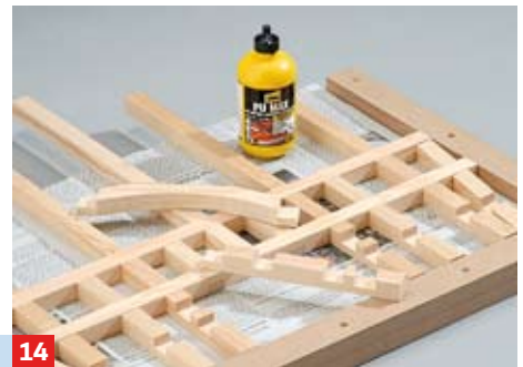
10 Um den gewölbten Türriegel bauen zu können, verleimen Sie zwei Leisten mit wasserfestem PU-Konstruktionskleber
