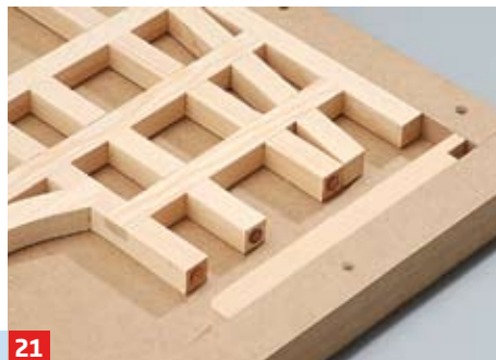
21 Die Türschwellen werden – wie bereits die Eckpfosten – mit den Giebelwänden verdübelt. Nicht durch die Überblattung ...
