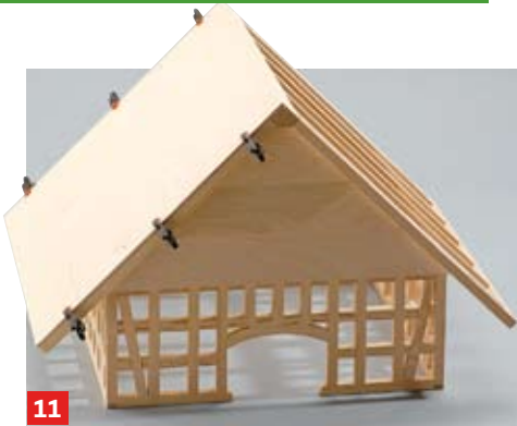
11 Anschließend werden die Dachflächen verschalt. Das um Materialstärke längere Sperrholz überlappend auf das kürzere aufkleben
