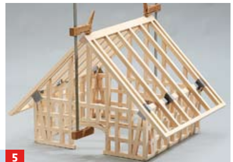
5 Gegenbohrungen fertigen, Leim angeben (auch auf die Dreiecksleisten), Dübel einsetzen und verpressen
