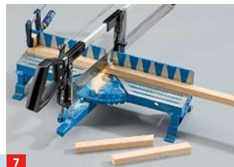
7 Um alle Hölzer exakt auf gleiche Länge schneiden zu können, fixieren Sie einen Längenschnitz auf der Gehrungssäge
