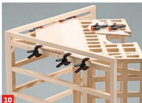
10 ... und leimen sie von unten nach oben überlappend auf. Verwenden Sie zum Fixieren kleine Leimklemmen
