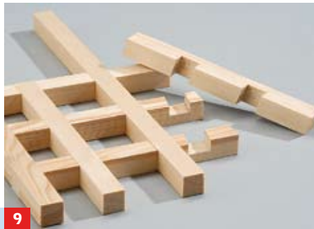
3 ... Strich stehen. Mit dem Stechbeitel vorsichtig abwechselnd von beiden Seiten die Überblattung ausstemmen
