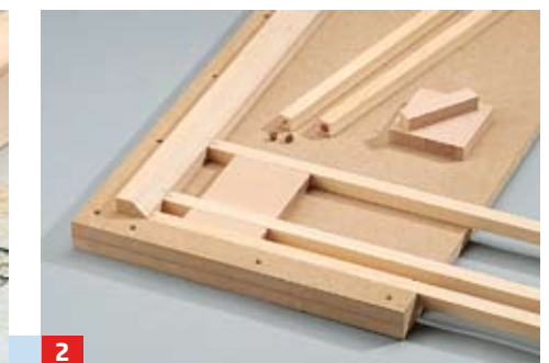
22 ... in die Eckpfosten dübeln! Anschließend werden die durchlaufenden Schwellen unter die traufseitige Wand gedübelt
