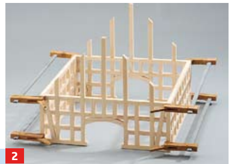
2 ... etwas Leim, richten Sie die 4 Wände mit einem Winkel (oder in der beschriebenen Lade) aus und fixieren sie
