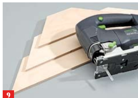
9 Die Giebel werden mit Sperrholz verschalt. Um die Fläche zu beleben, schneiden Sie drei Streifen mit der Stichsäge zu ...
