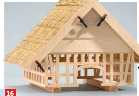
16 PU-Klebstoff an die Überblattung und die Außensparren geben, Ortgangblenden einlegen und mit Klemmen fixieren
