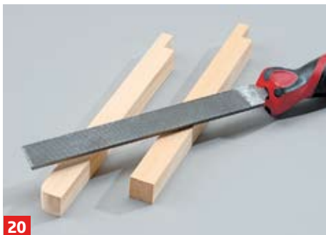
20 Nun die Türschwellen ablängen, danach die nach innen zeigenden Köpfe abrunden und die Überblattungen fertigen
