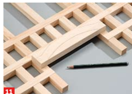
11 Kontrollieren Sie die exakte Länge des Türriegels und zeichnen die im Bauplan angegebenen Umriss auf das Bauteil
