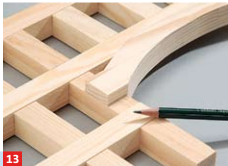
9 Wie in Bild 2 und 3 oben beschrieben, müssen Sie die Hölzer nun einsägen, stemmen und auf Passgenauigkeit prüfen
