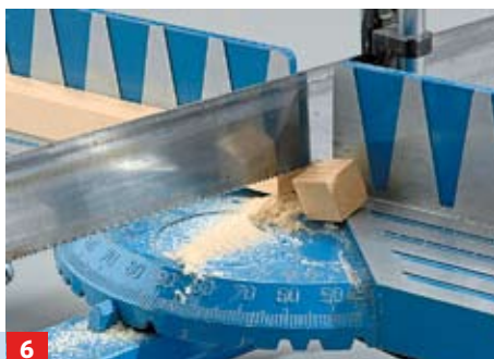
6 Nun schneiden Sie mit der Gehrungssäge die Winkel an einem Kopfholzende der Büge (s. „Fachwerkskonstruktion“ unten)
